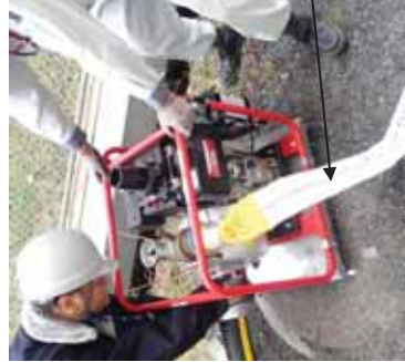
エンジン付きポンプ仕様 性能: 1 m 3 /min(Max)
