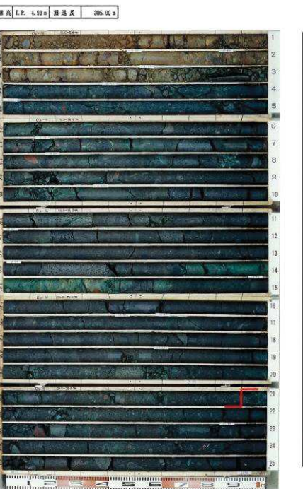
O3-4孔・地質柱状図及びコア写真
