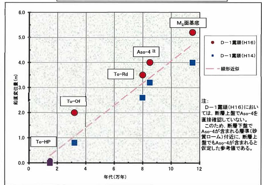
第4.3-25図 出戸西方断層の平均変位速度検討図
