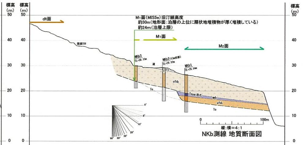
第4.3-46図(1) 六ヶ所村中山崎周辺の地質断面図 (NK f 測線, NK a 測線, NK b 測線)
