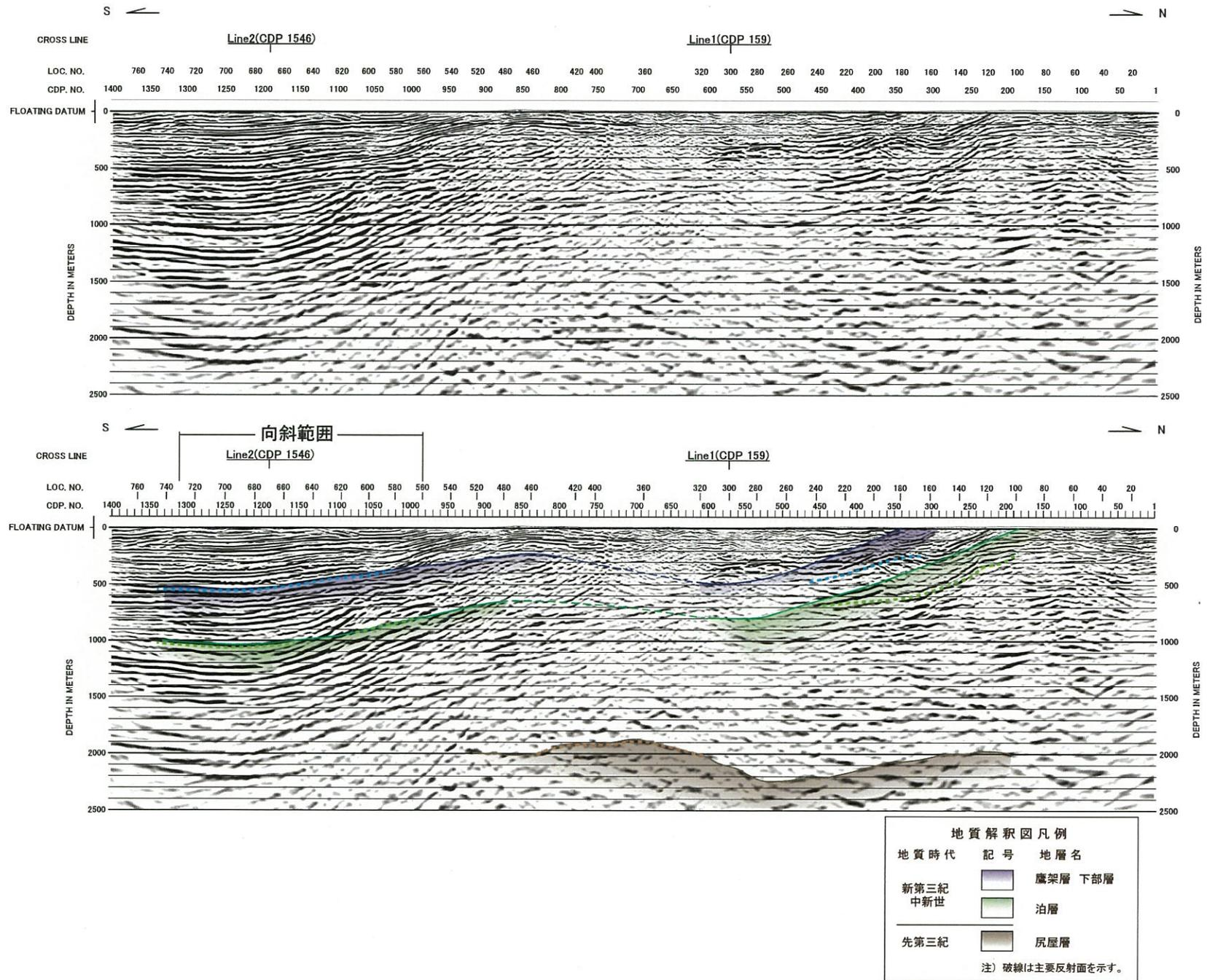
第4.3-7図(4) 敷地近傍の反射法地震探査結果図 (Line B: 深度断面)
