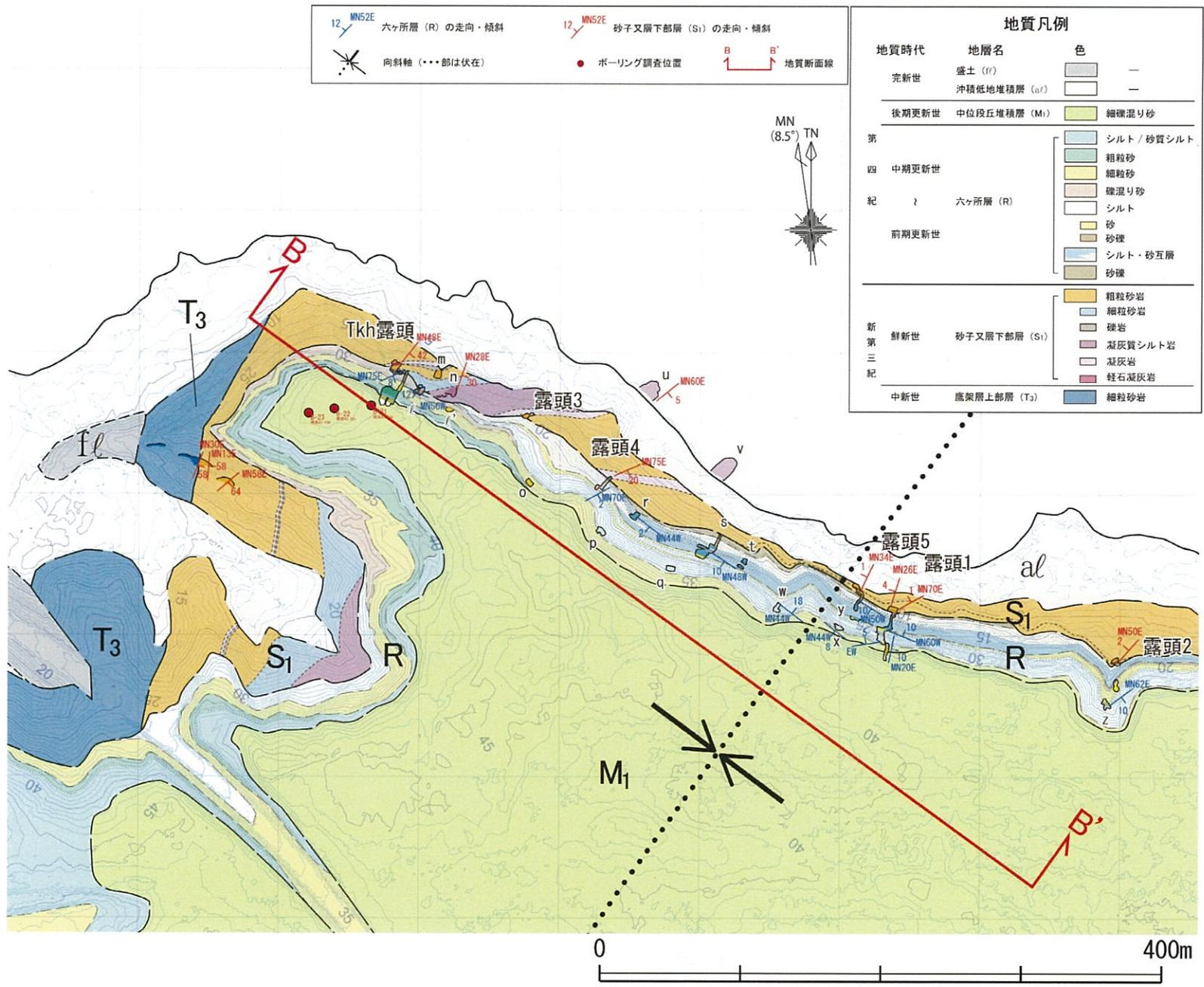
第4.3-36図 鷹架沼南岸の向斜構造西翼部の地質平面図
