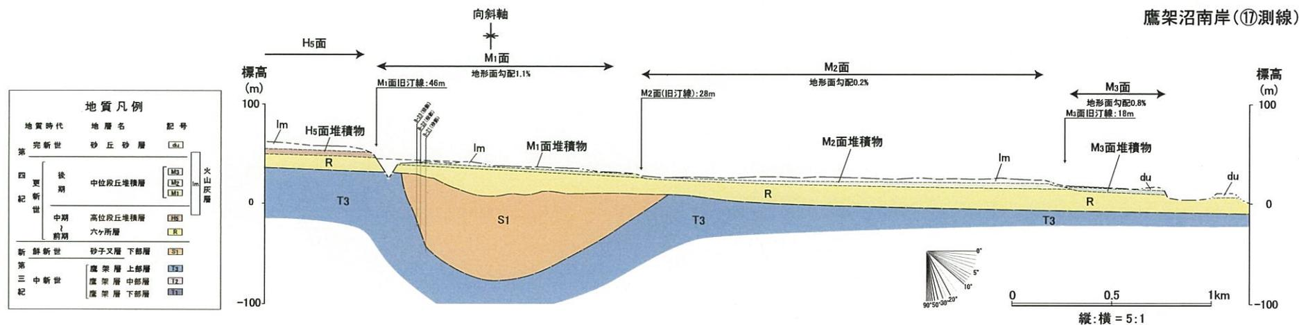
第4.3-33図 尾駈沼南岸及び鷹架沼南岸の地質断面図
