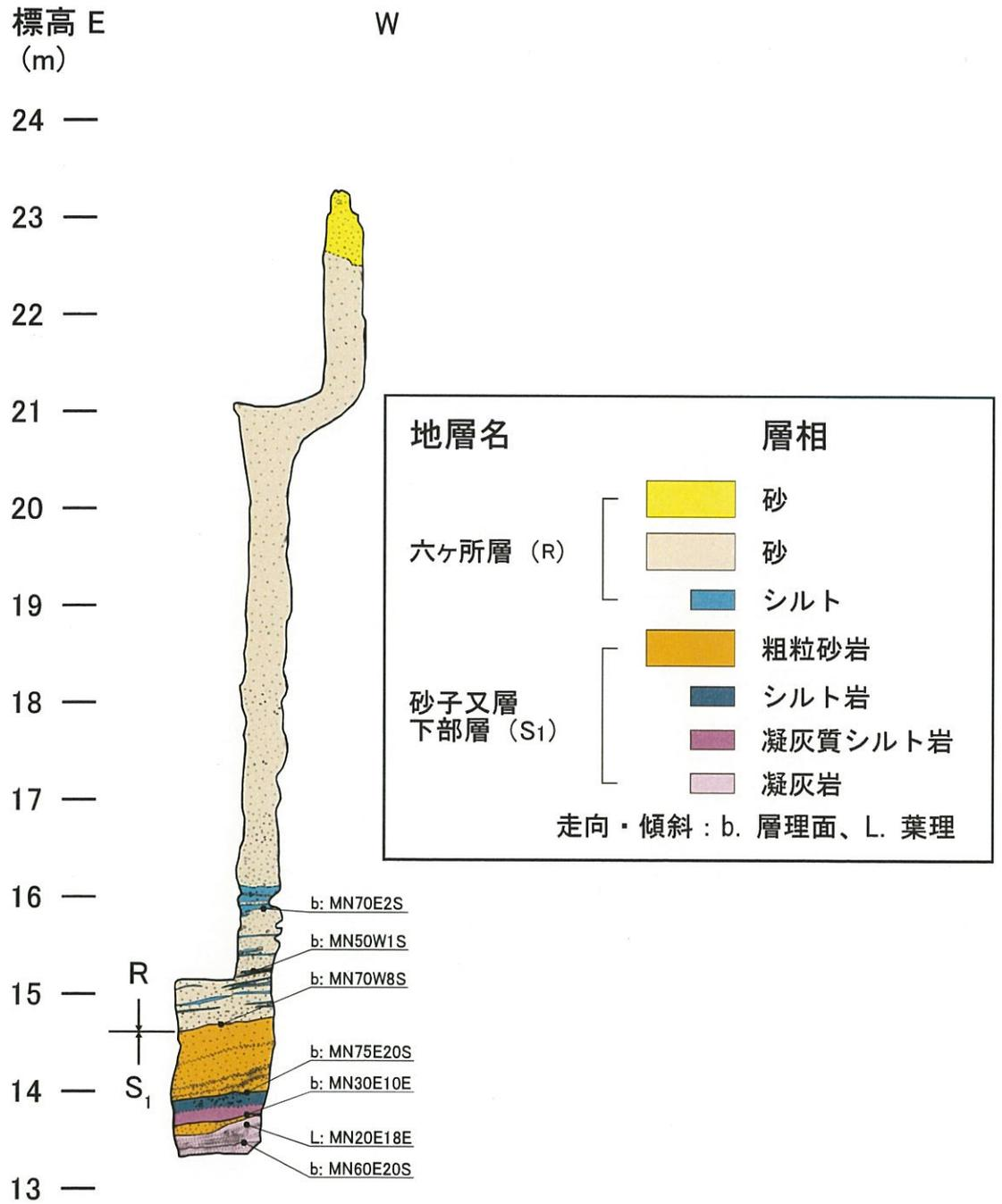
第4.3-38図(5) 鷹架沼南岸の露頭スケッチ図 (露頭4)
