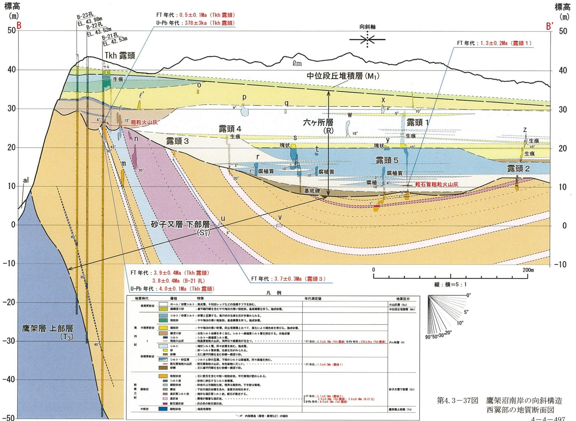
第4.3-37図 鷹架沼南岸の向斜構造西翼部の地質断面図
