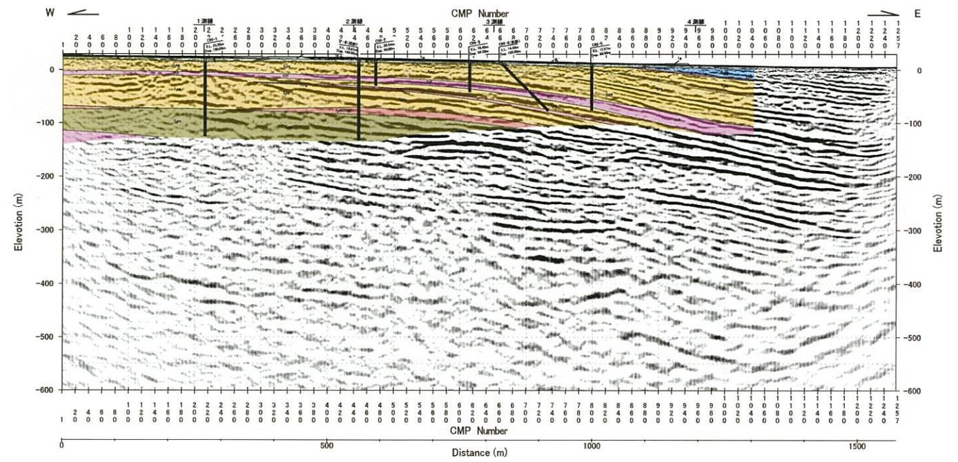
第4.3-28図(1) 出戸西方断層南方の反射法地震探査結果図 (①測線：深度断面)
