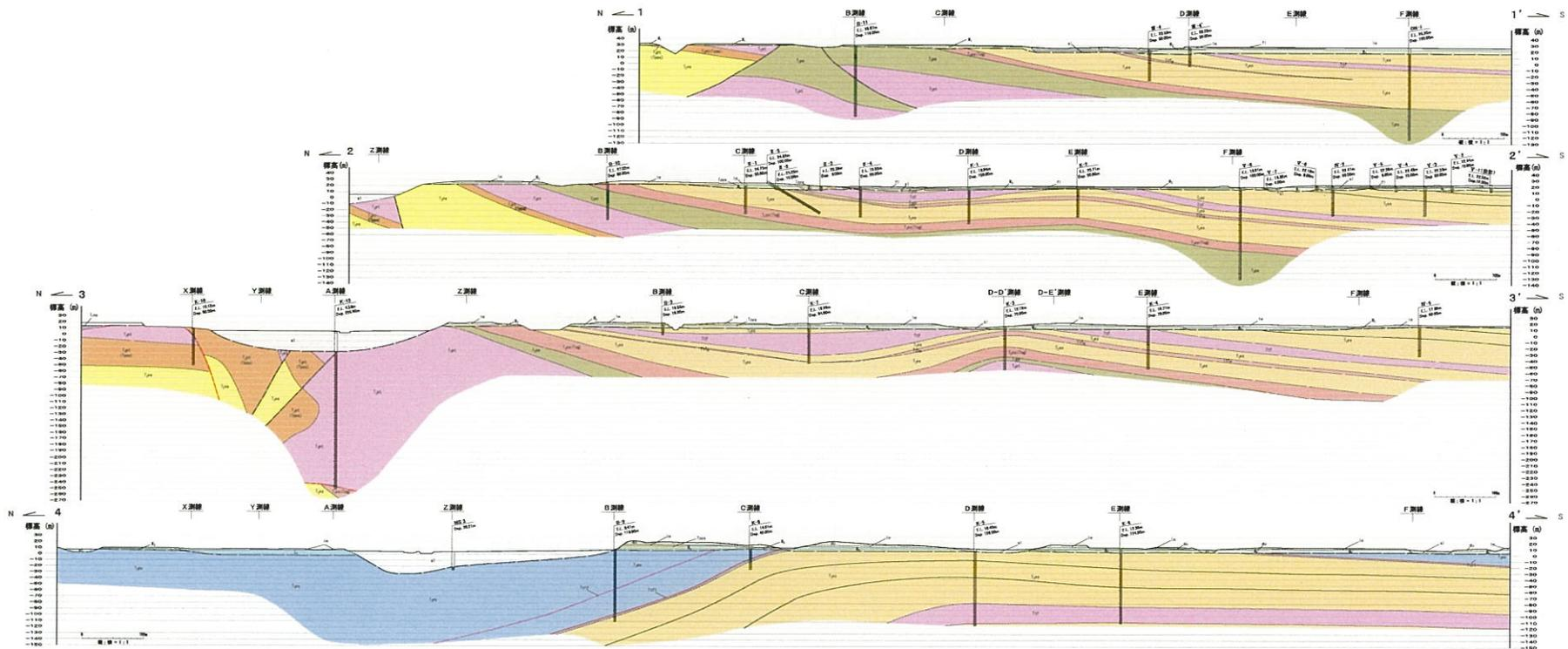
第4.3-27図(4) 出戸西方断層南方の地質断面図 (1-1', 2-2', 3-3', 4-4' 断面)
