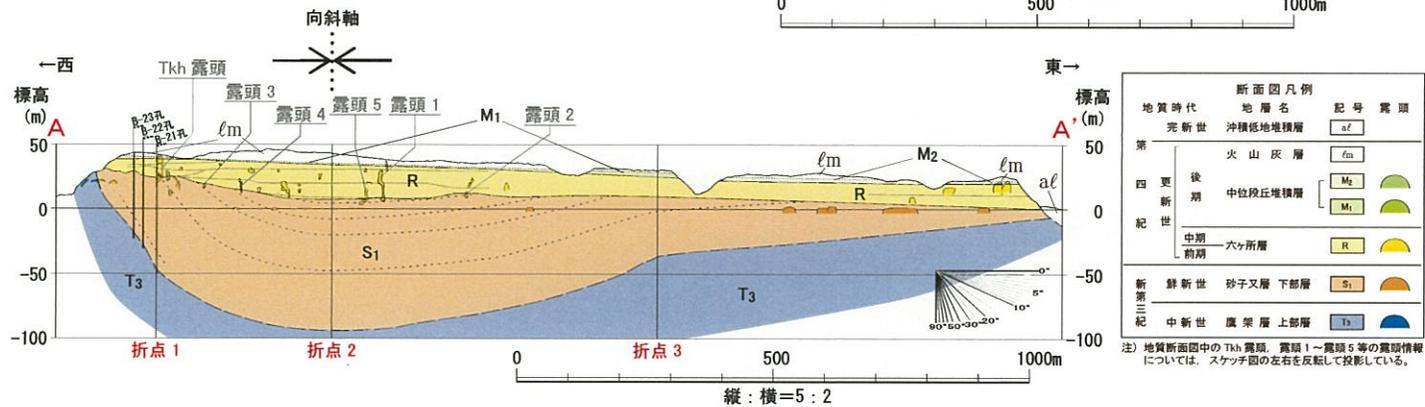
第4.3-35図 鷹架沼南岸の地質平面図及び地質断面図
