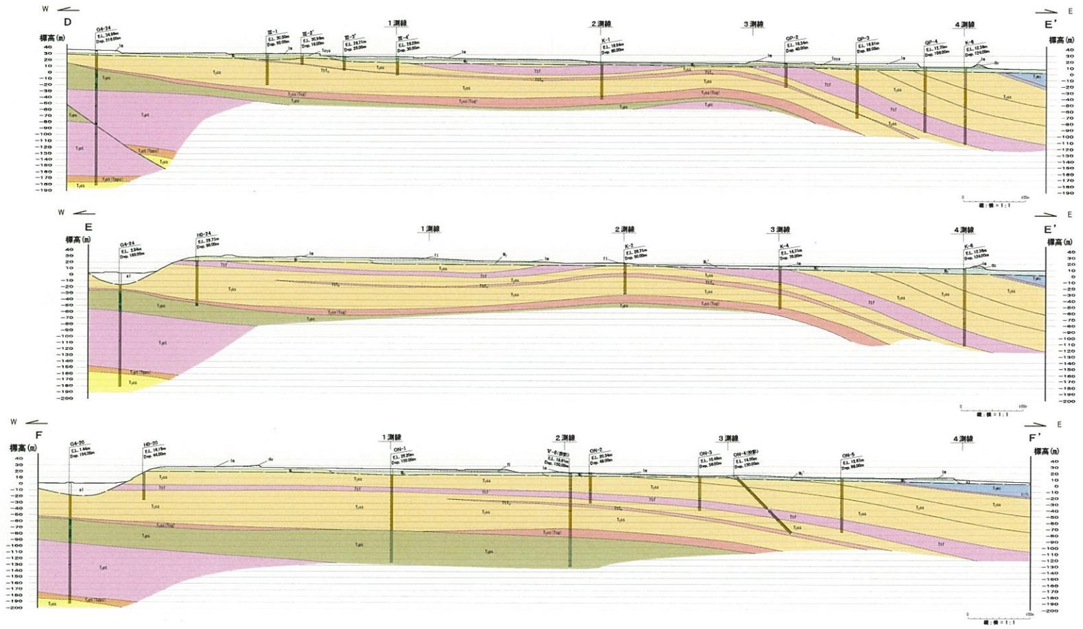
第4.3-27図(3) 出戸西方断層南方の地質断面図 (D-E', E-E', F-F' 断面)
