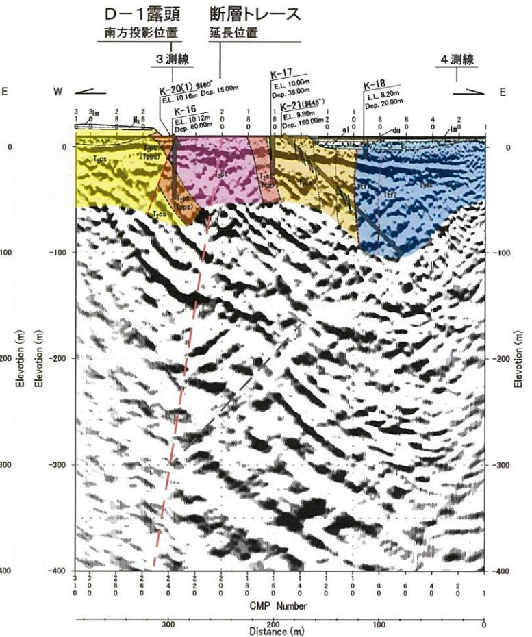
第4.3-28図(2) 出戸西方断層南方の反射法地震探査結果図 (②測線：深度断面)
