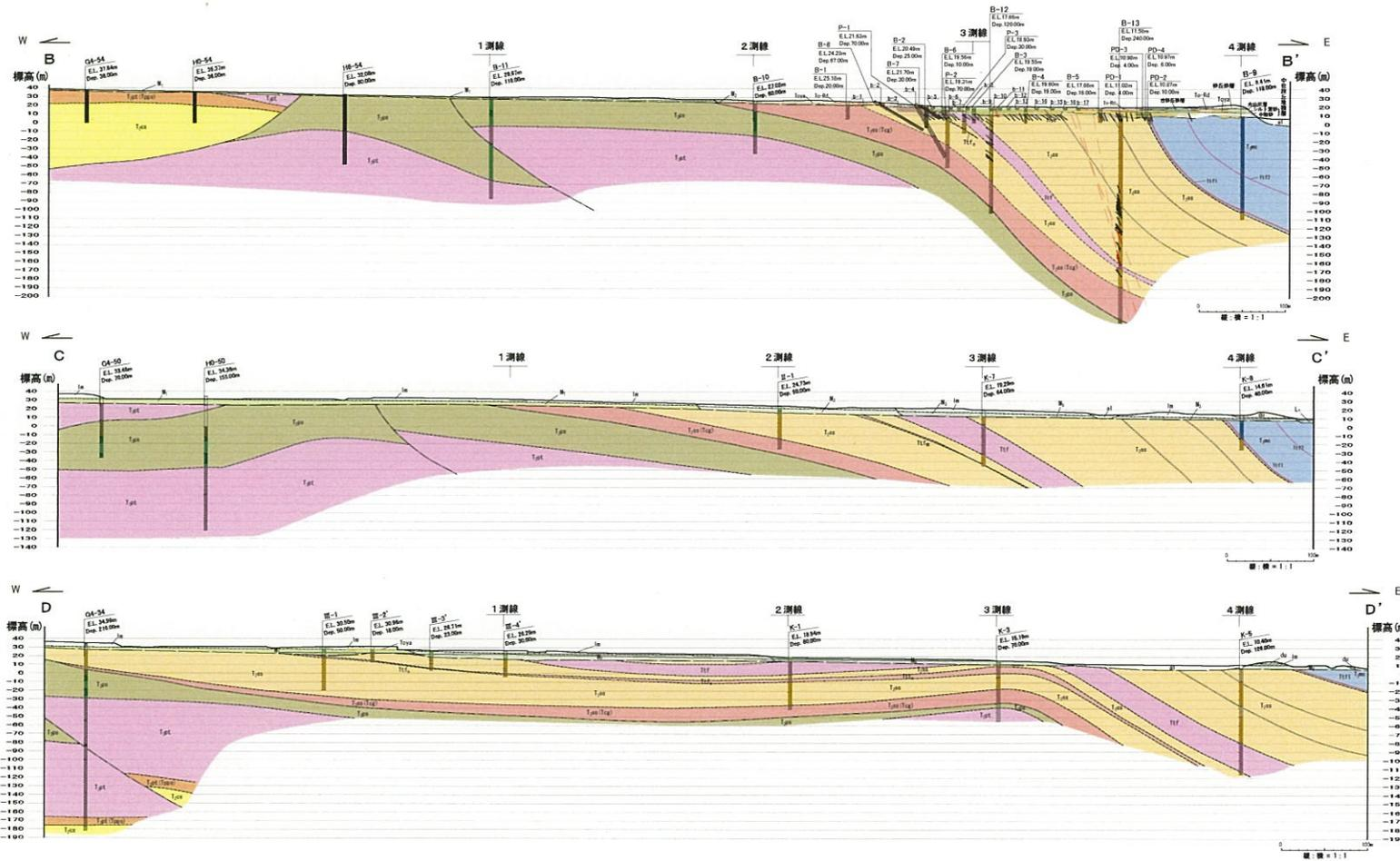
第4.3-27図(2) 出戸西方断層南方の地質断面図 (B-B', C-C', D-D' 断面)
