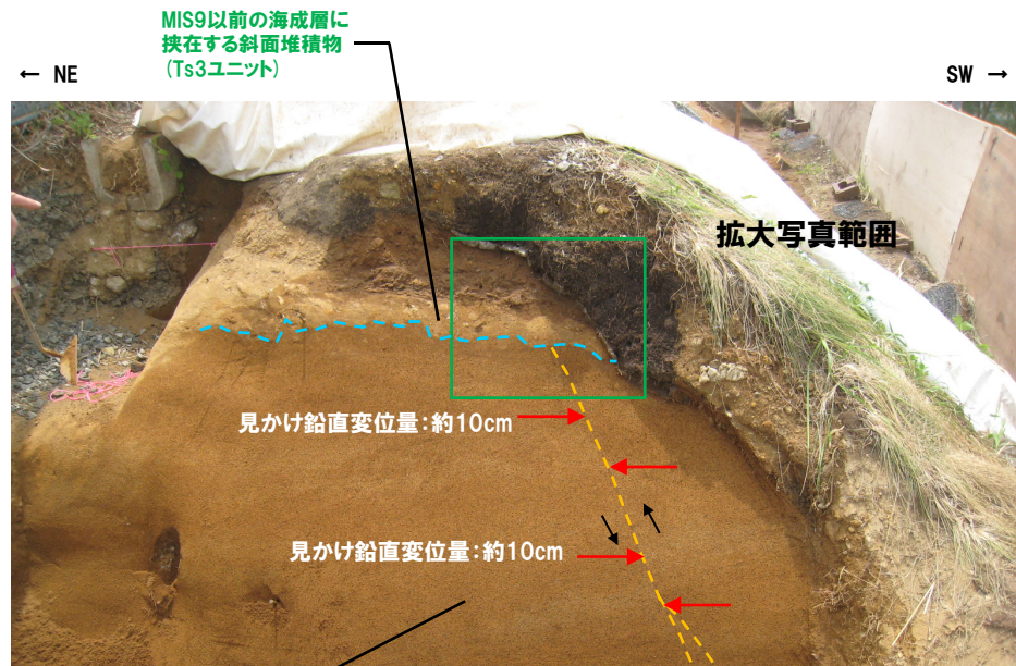
MIS9以前の海成層 (M1ユニット) 開削調査箇所(南側) 南側壁面 小断層上端付近 拡大写真(解釈線あり)
