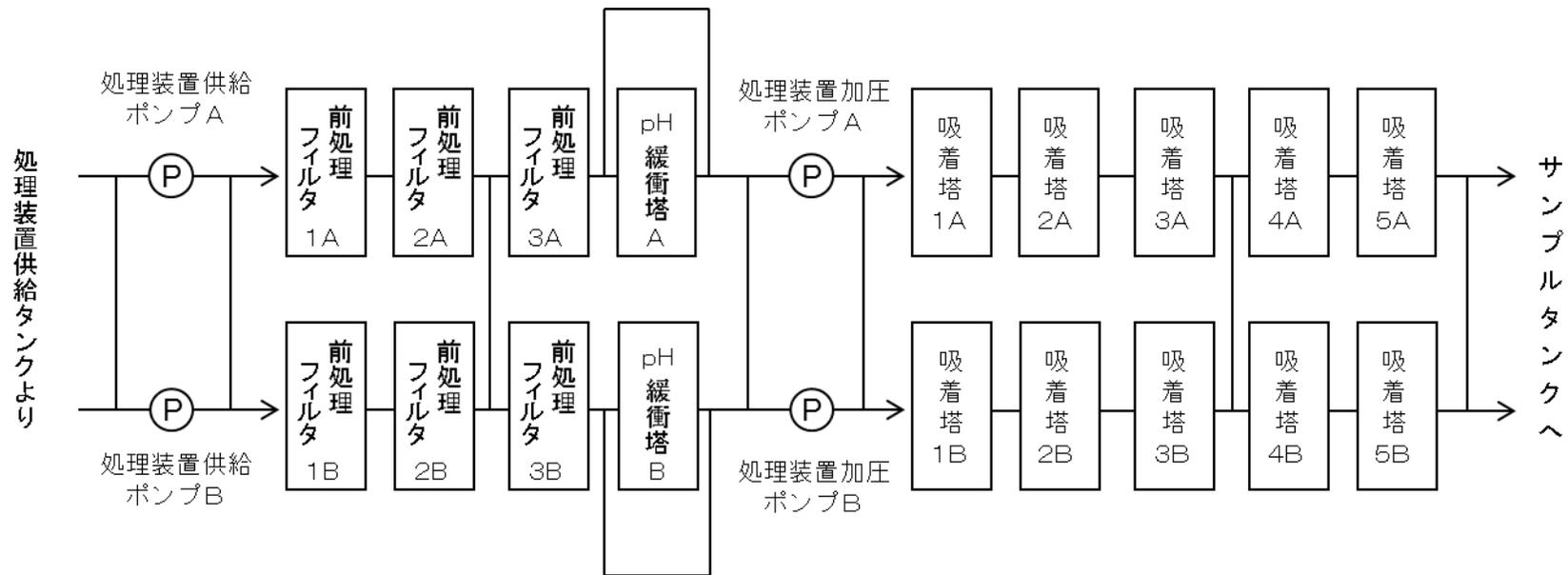
図-3 サブドレン他浄化装置系統構成図
