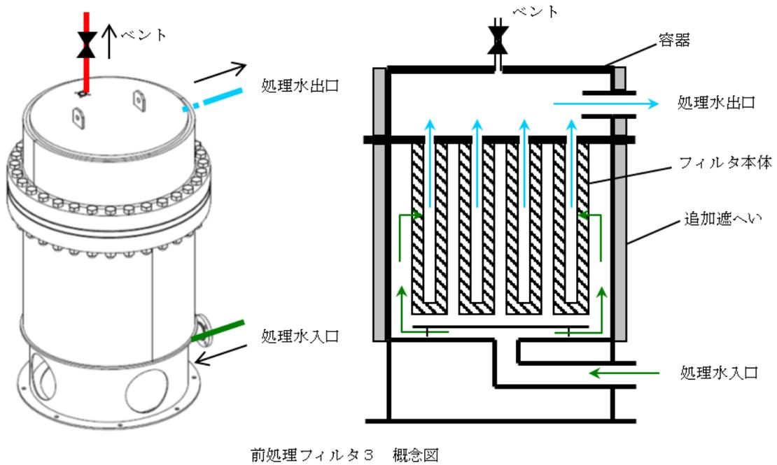
図-4 サブドレン他浄化装置 前処理フィルタの概念図
