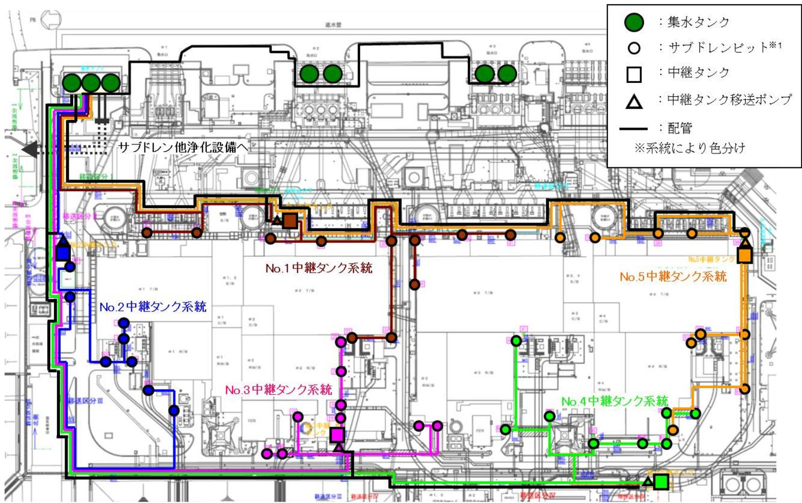
※1 揚水ポンプおよび水位計は、サブドレンピット内部に設置されている。(揚水ポンプ：各ピットに1台ずつ、計46台、水位計：各ピットに2台ずつ、計92台)
