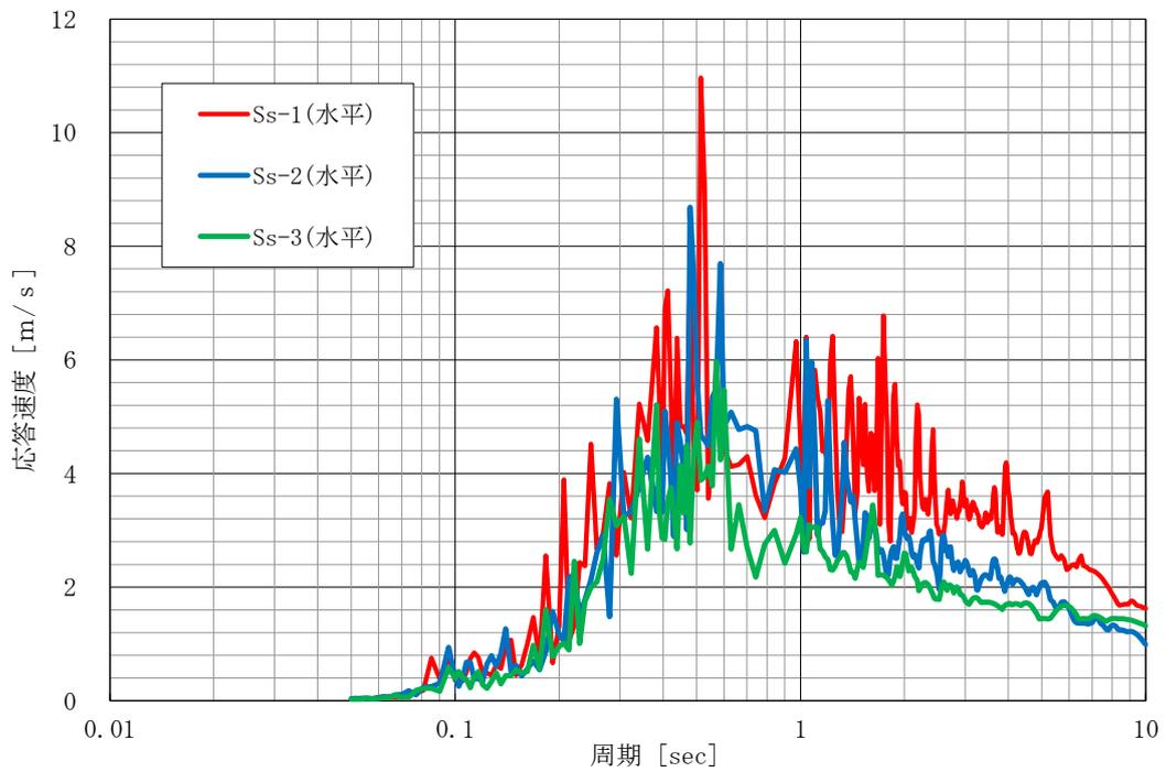
速度応答スペクトル（水平方向・減衰なし）
