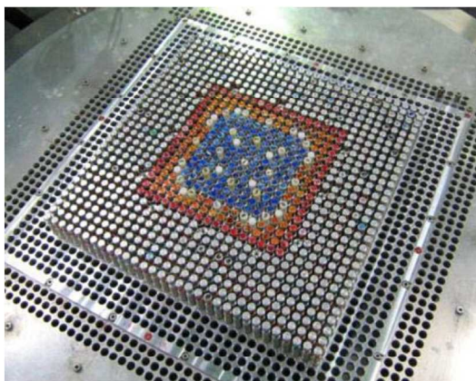
PWR燃料の模擬炉心
