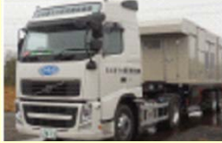
予備 移動式発電機 (分散配備)
