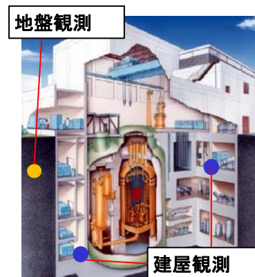
原子力施設の地震観測システム (原子力規制庁との共研)
