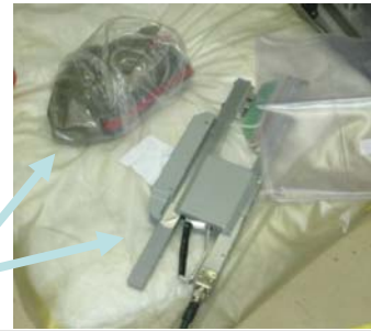
汚染発生原因となった梱包用熱溶着装置
