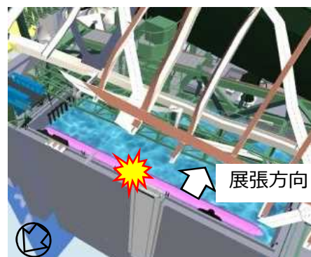
養生バッグ投入完了
