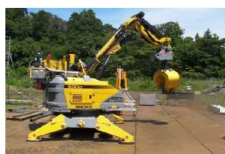
BROKK400D 主な役割 ・転倒防止対策用スロープ設置 ・γカメラ撮影 等
