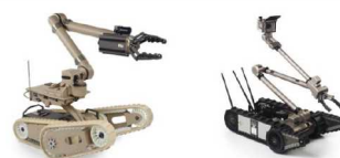
Kobra (左) Packbot (右) 主な役割 ・表面/空間線量率測定、表面汚染測定 ・調査助勢 等
