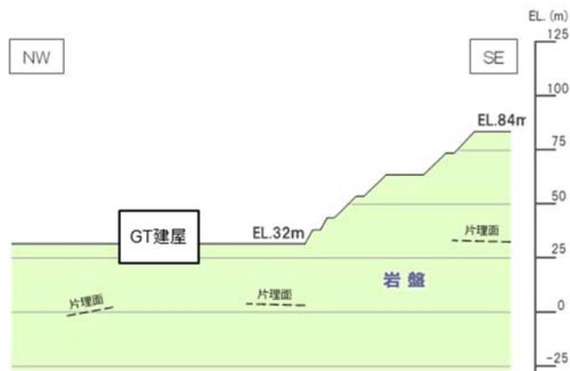
第1-5図 GT建屋の周辺斜面に対する評価断面（断面図）
