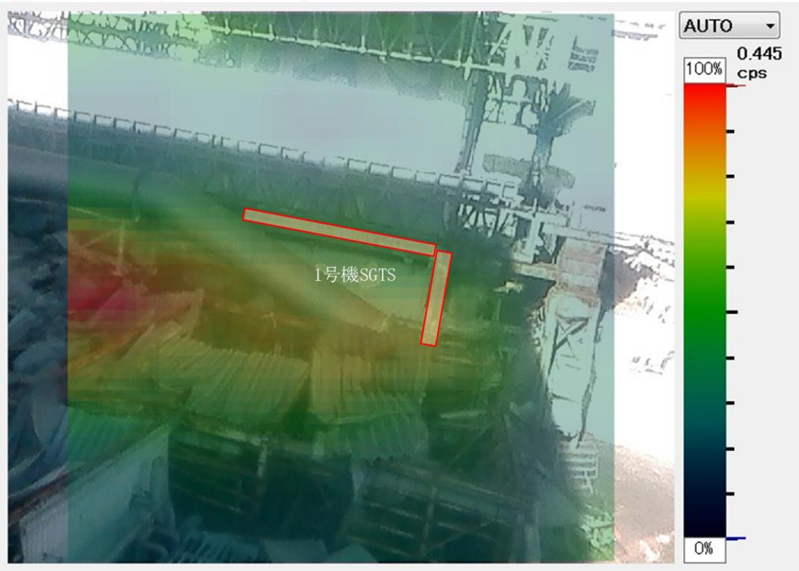
第1図 Cs-137全エネルギー吸収モードによる測定画像
