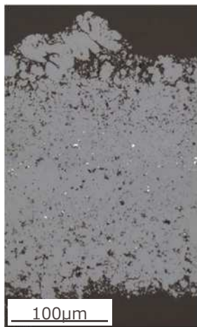
スラッジの断面観察結果 (C-SGより採取)
