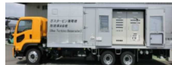
ガスタービン発電機
