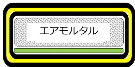
養生バッグ概略構造 (断面)
