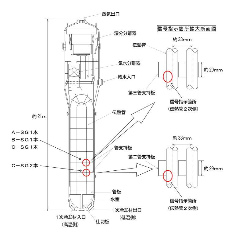
高浜4号機 SG伝熱管ECT結果
