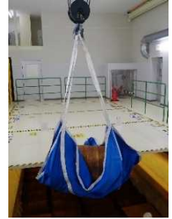
モッコ式吊り具による取出し
