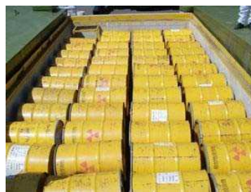
ピット内の保管体
