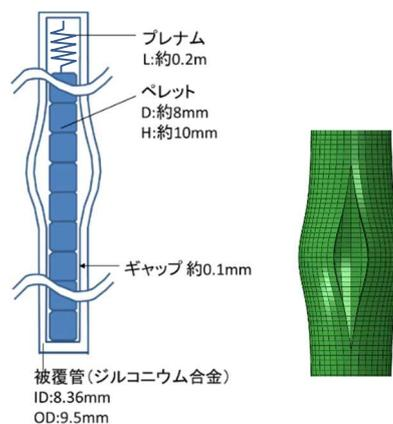
図2 バースト燃料棒概略図
