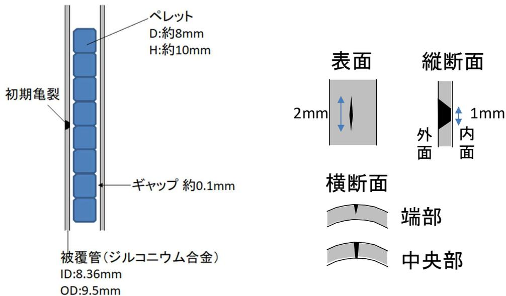
図4 PCMI解析用燃料棒モデル及び被覆管亀裂のイメージ
