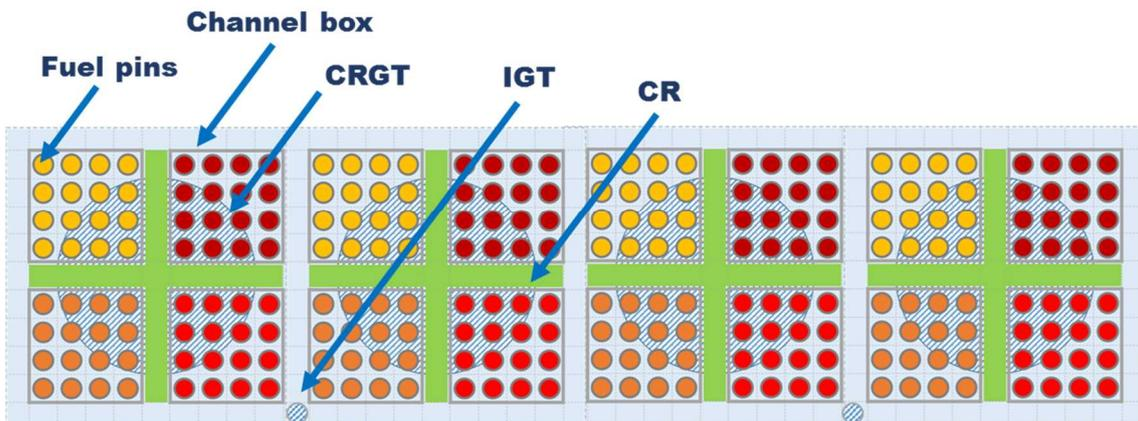
図 3 詳細幾何形状モデルの径方向への拡張検討 (4×1 詳細幾何形状モデル)
