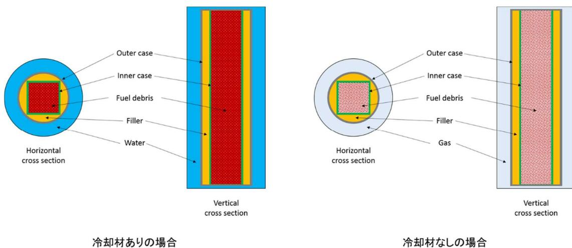
図 5 燃料デブリ収納缶の線量評価
