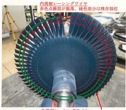
外周側レーシングワイヤ 赤色点線部が脱落、緑色部分は残存部位 R側過給機の内周側レーシングワイヤー本のうち1本の脱落を確認
