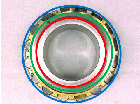
タービン側 ころ軸受外観
