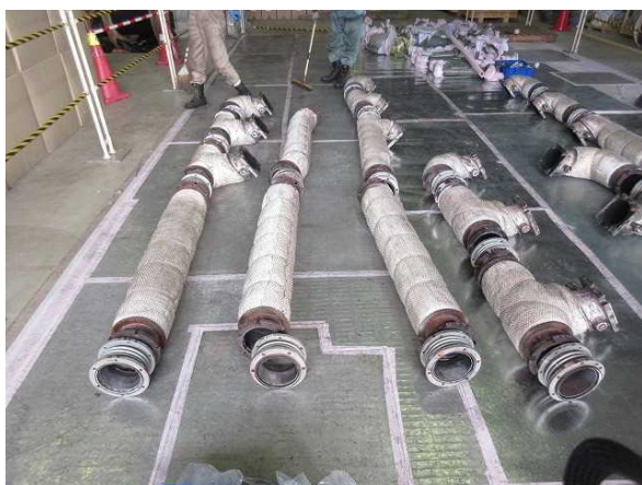
L側排気管・伸縮継手
