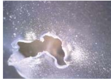
試験による穴(約6.65mm)
