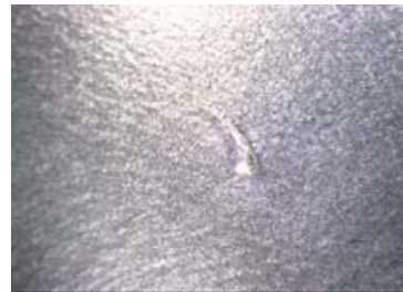
試験による傷(約1.95mm)
