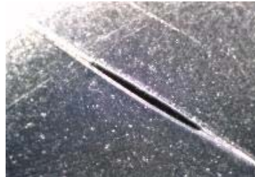
試験による穴(約4.35mm)
