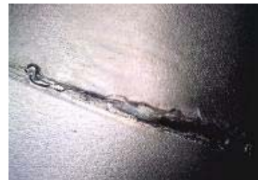
試験による穴(約13.45mm)
