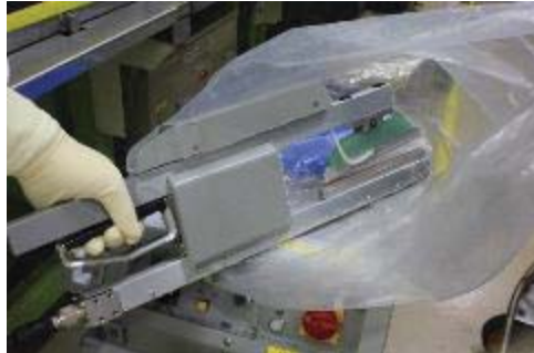
粉末調整室(A-103)で使用していた熱溶着装置
