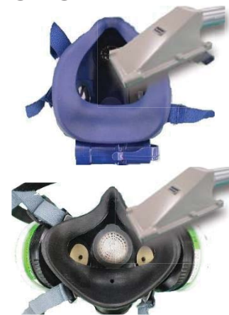
図4.2.24 半面マスクの脱装時における頭頸部・顔面の汚染検査手順
