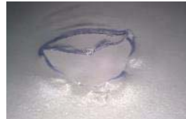
試験による穴(約4.90mm)
