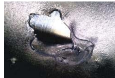
試験による穴(約4.93mm)
