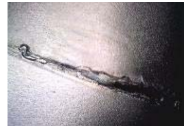
試験による穴(約13.45mm)
