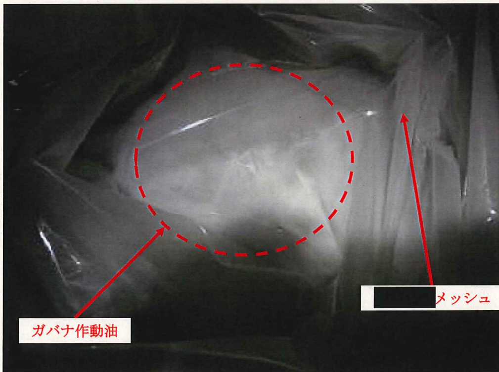
ガバナ作動油を濾した [blacked out] メッシュ (※1インチ間による目数が [blacked out] 個のメッシュにガバナ作動油を濾した写真)
