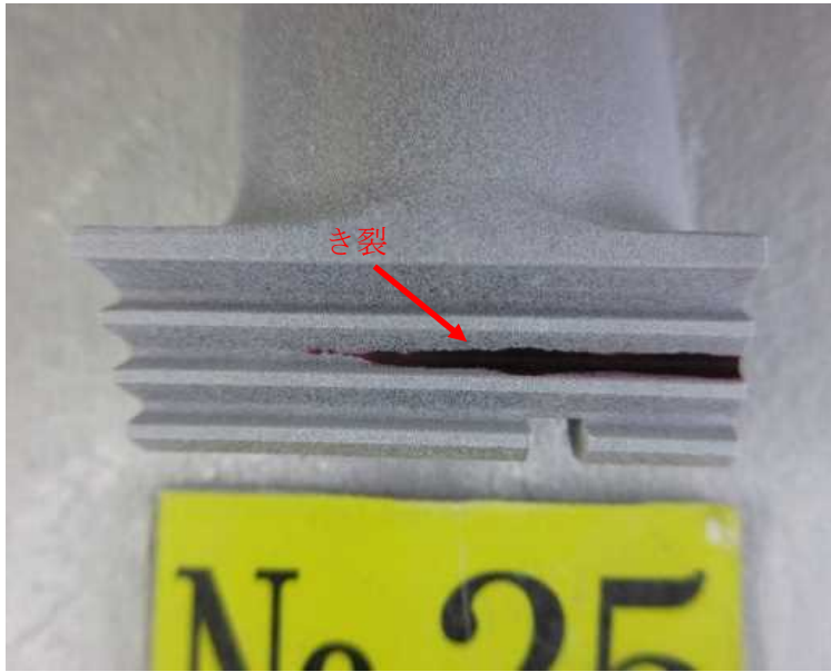
L側過給機のタービンブレード 浸透探傷検査指示模様
