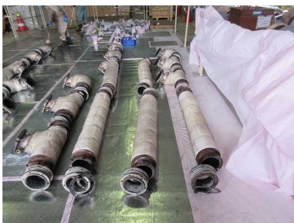
R側排気管・伸縮継手
