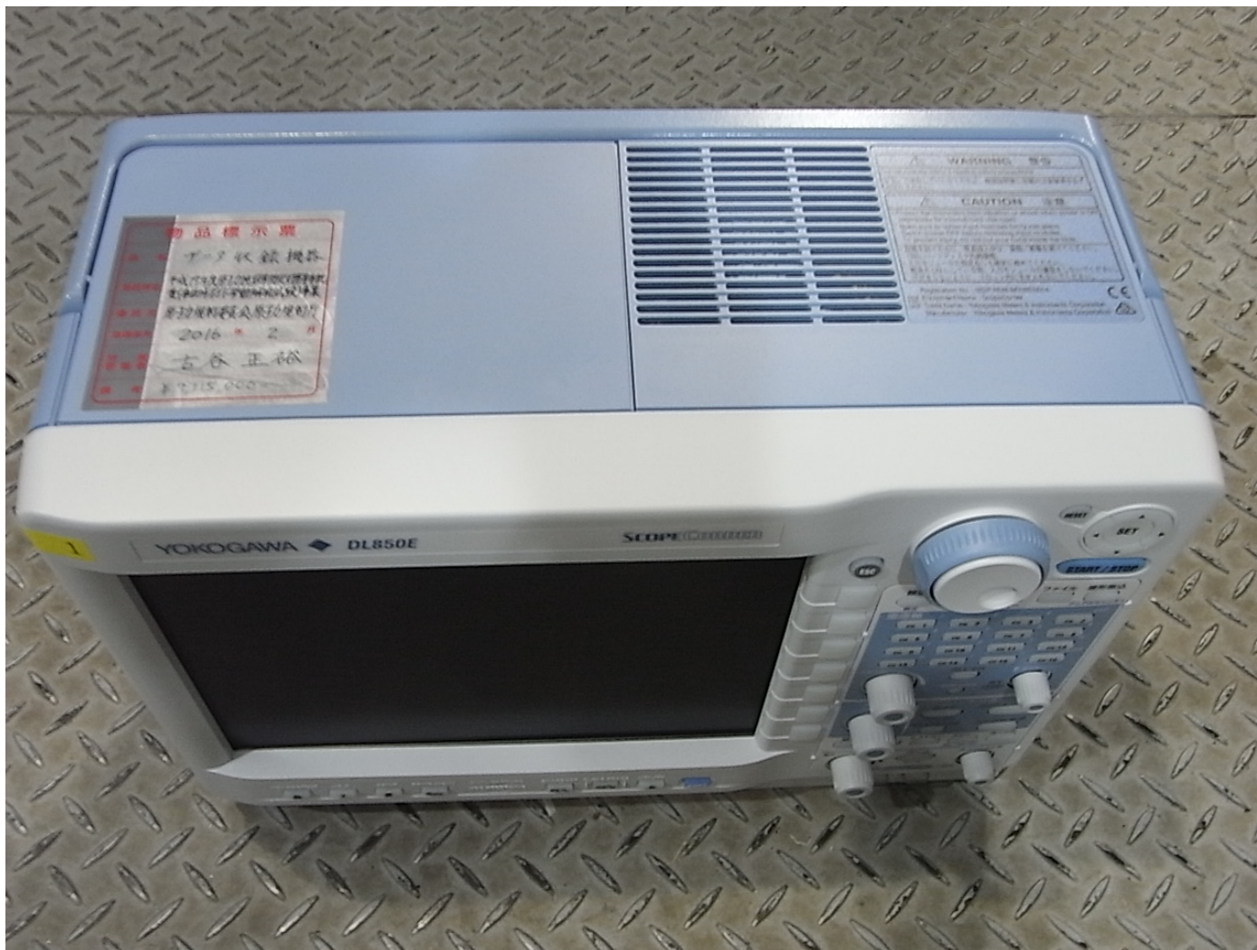
図 54 ボイド計測用信号収録機器
