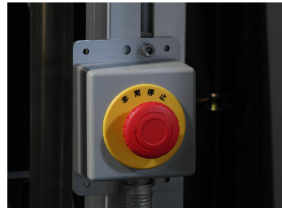
図 12 非常ボタン固定設置
