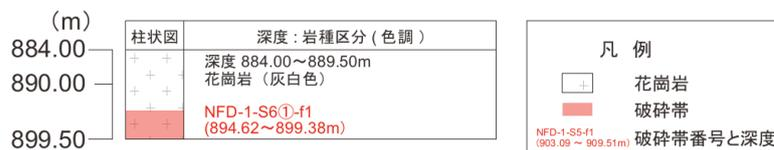
図 4.4.2.1 NFD-1-S6①孔 柱状図
