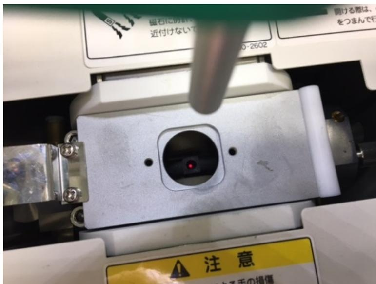
図 4.3. 原子吸光度計に放射温度計をセット
