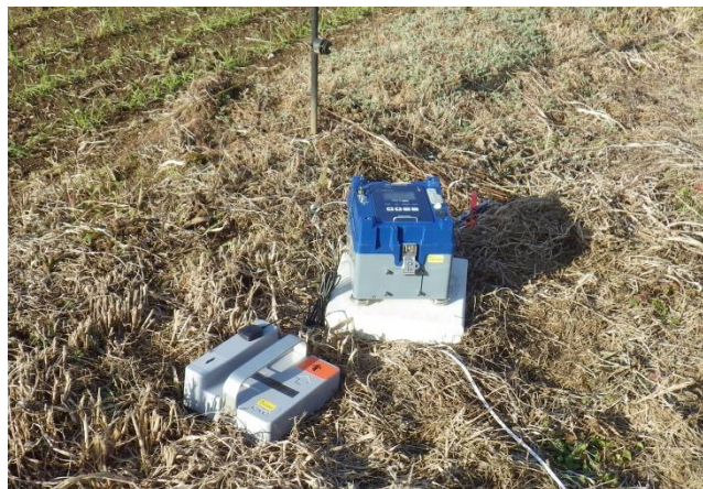
図 3.34 微動計設置状況
