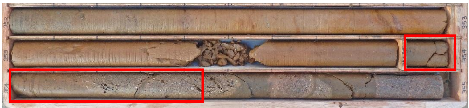
図 4.33 FDB-1 孔 353.9~354.9m 間のコアスケッチ及びコア写真
