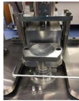
⑥中型の固定ボルトを取り外す
