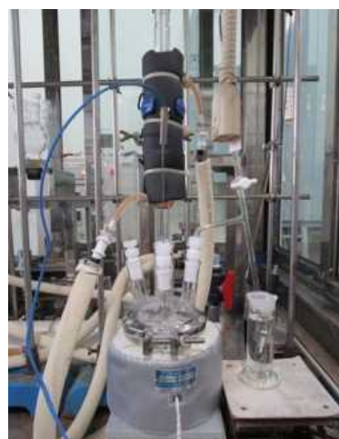
図 2.2.3 電気化学特性試験装置の概略図及び外観
