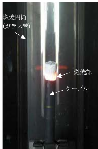
図 2.8 JIS K 7201-2:2007 を参考とした酸素指数試験 (同時劣化 SiR ケーブル 1) (参 2.22)
