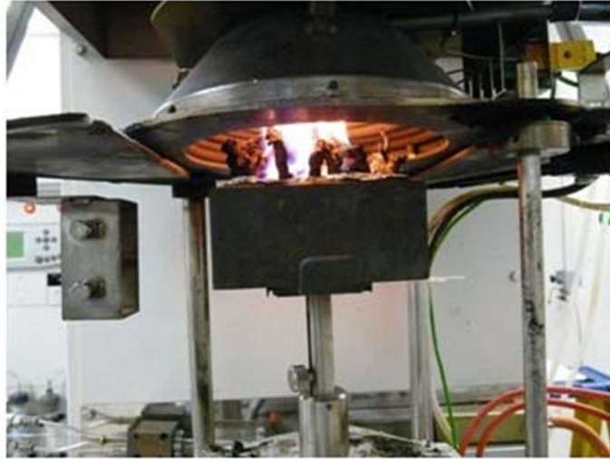
図 2.1.1-1 コーンカロリメータ試験 (参4)
