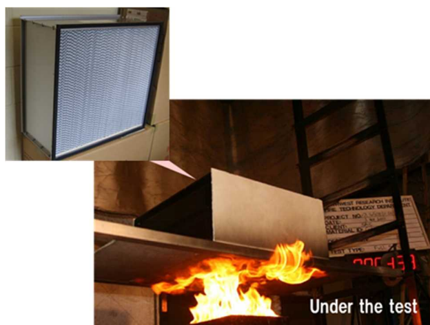
図2.1.4-1 フィルタ火災試験 (参5)
