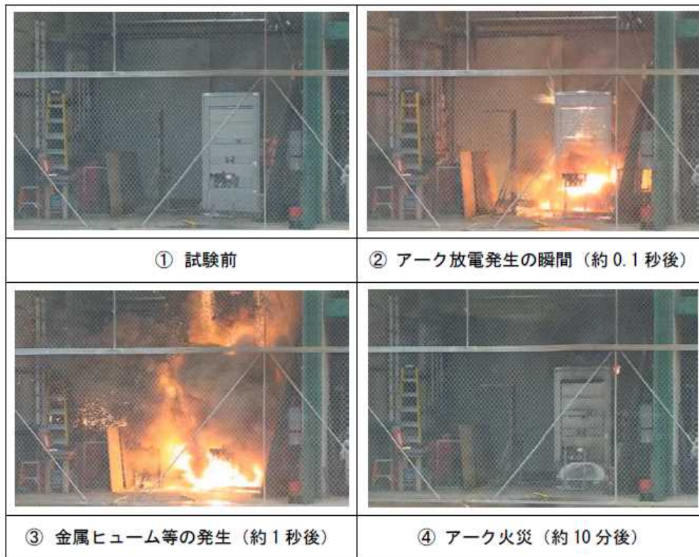
図 2.1.6-4 配電盤の HEAF 試験 (参1)
