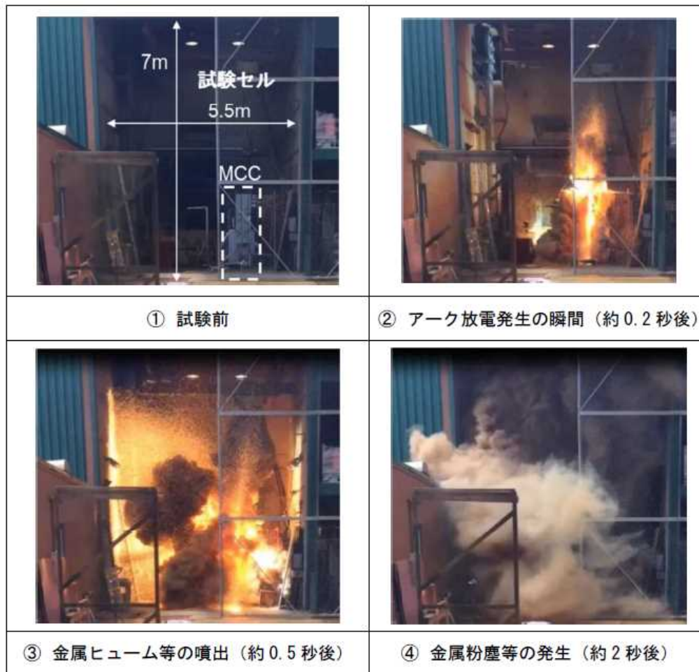
図 2.1.6-5 モータコントロールセンタの HEAF 試験 (参1)
