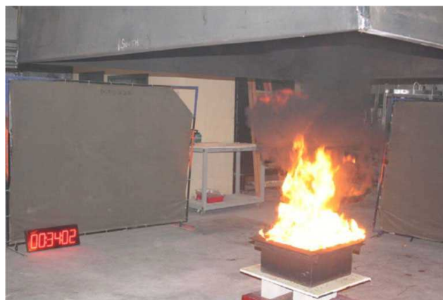
図 2. 1. 3-2 プール火災試験 (参4)
