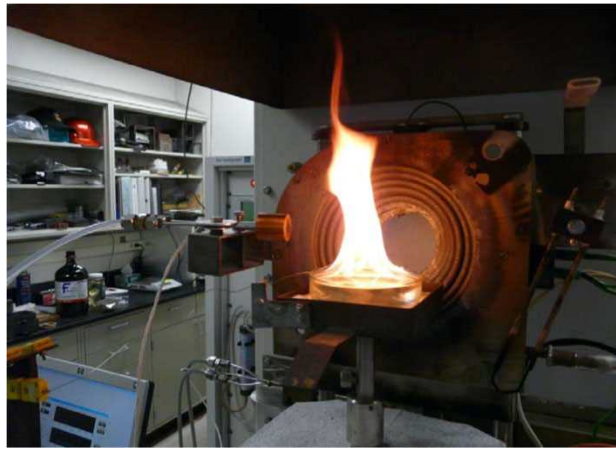
図 2. 1. 3-1 コーンカロリメータ試験 (参5)
