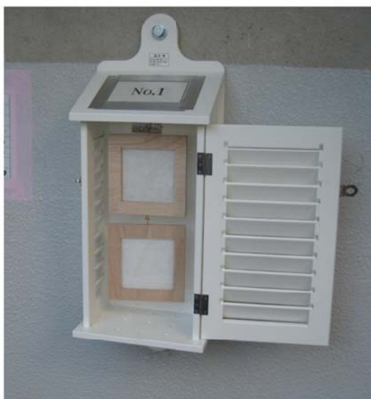
図 4. 1. 4-2 飛来塩分捕集器 (ドライガーゼ法)
