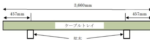
第2図 ケーブルトレイ設置方法
