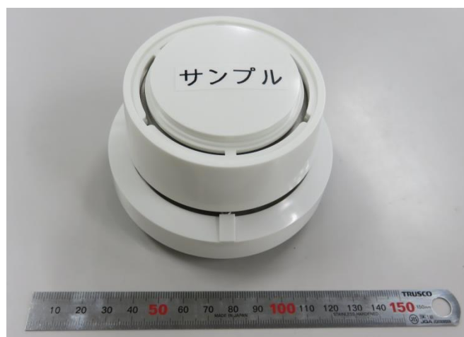
写真 1. イオン感知器の外観 (直径約 10cm、高さ約 7cm)
