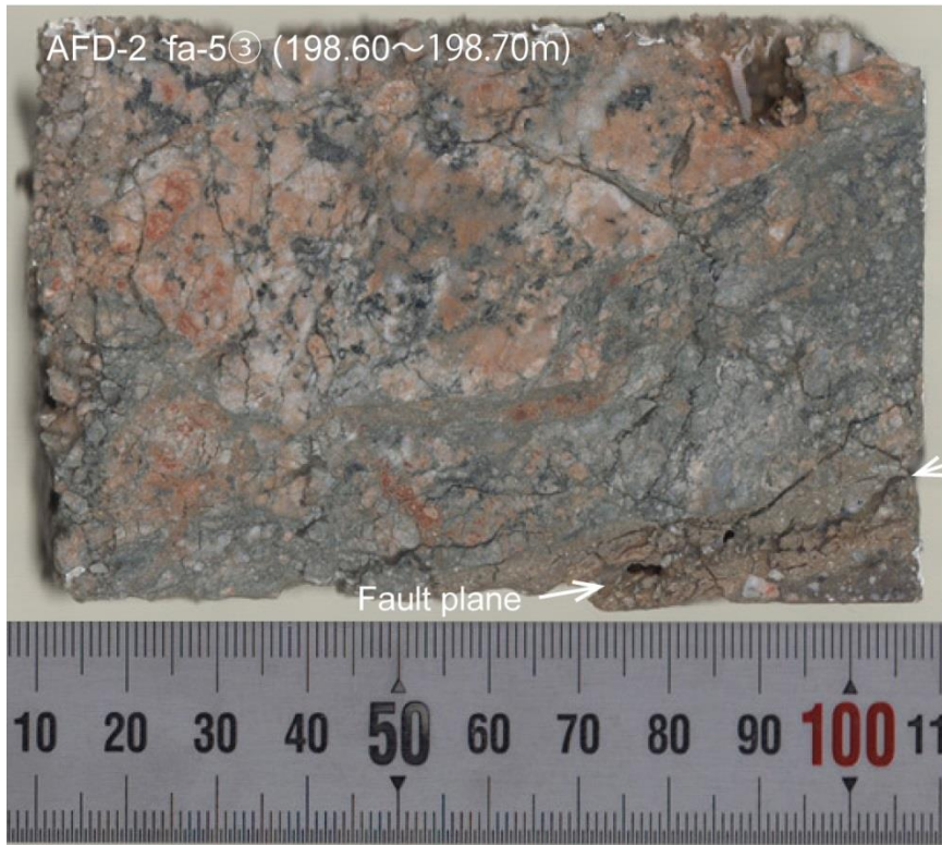
図 3.2.2.5. AFD-2 孔コア破砕帯 fa-5③のハーフカット研磨面 (図 3.2.2.4 の下半分)
