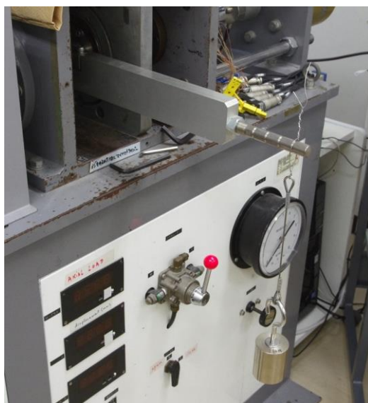
図 4.2.2.3. トルク検定装置（試験機から水平に伸びる金属バーおよび金属ワイヤーとステンレス製おもり）を用いてトルク計測部の校正を行っている様子
