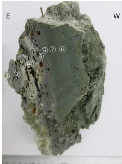
図 3.2.2.2. 小倉トレンチ南壁から採取された断層ガウジ試料②～⑥と 大阪層群粘土層試料⑦～⑧（最新活動面は⑤と⑥の間）
