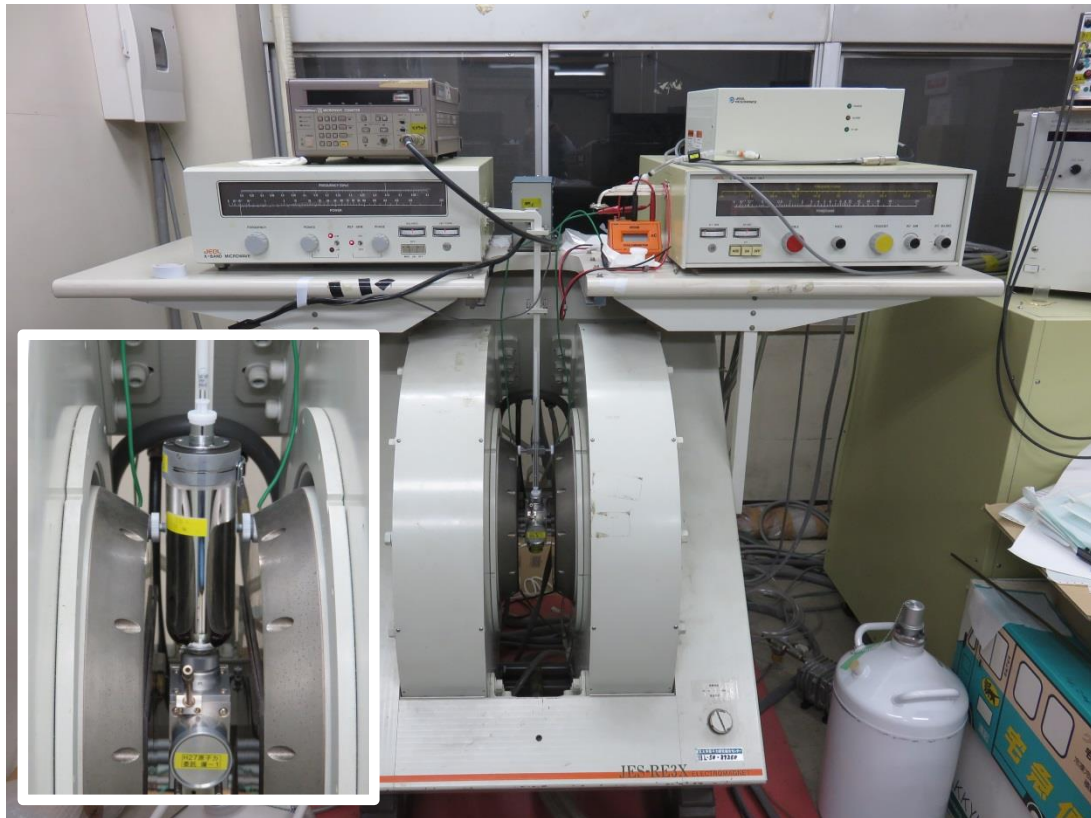
図 3.2.2.8. ESR 解析システム。白線内はキャビティにダブルチューブを取り付けた状態。
