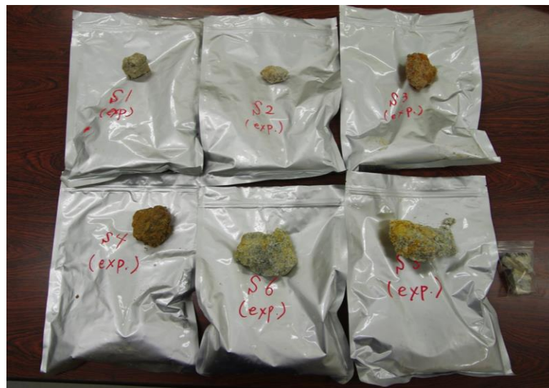
図 4.2.2.2. 小倉トレンチ南面および東面から採取した花崗岩試料。 採取したそれぞれの試料の一部を袋から出して撮影。
