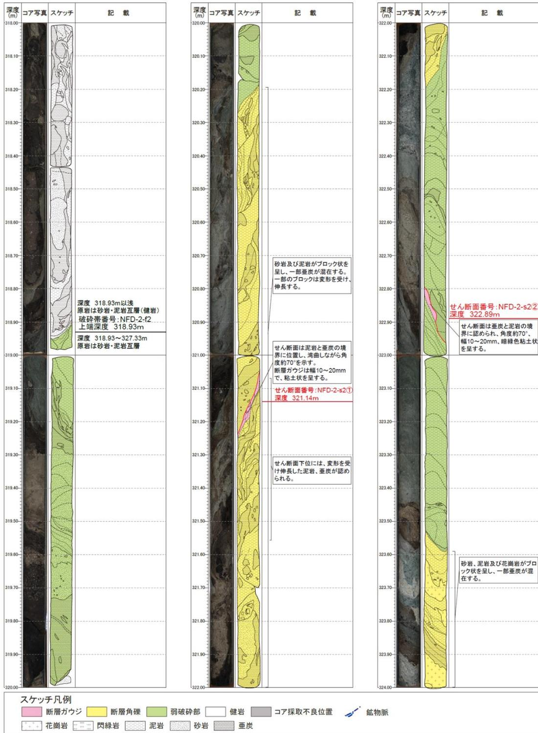
図4.3.2.3 破碎帯NFD-2-f2調査結果図 (1)
