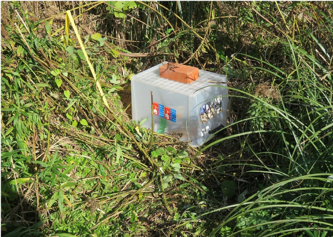
地震計設置状況（チェーンアレ-）
