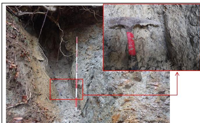
P13 結晶質凝灰角礫岩体中の断層 (F8)
