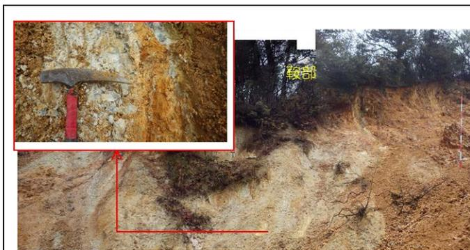
P10 花崗岩体中にみられる断層 (F5') 断層両端の花崗岩体は硬質。節理によりブロック化する。断層周辺は破碎作用により脆弱化しており、ハンマー打撃により容易に崩せる。断層粘土は幅 10cm 程度、脆弱部は幅 8m 程度。
