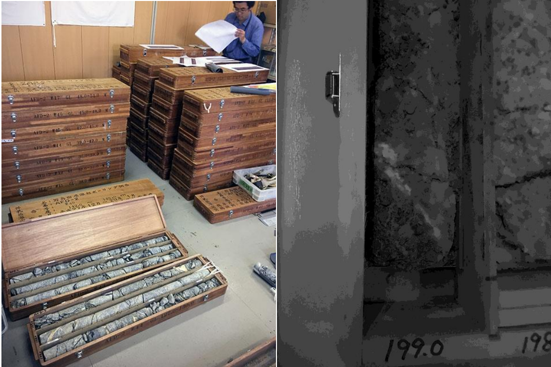
図 4.2.2.1. 掘削コアと断層破碎帯の部分。暗室のため詳細は観察されないが数 mm の幅をもつ。
