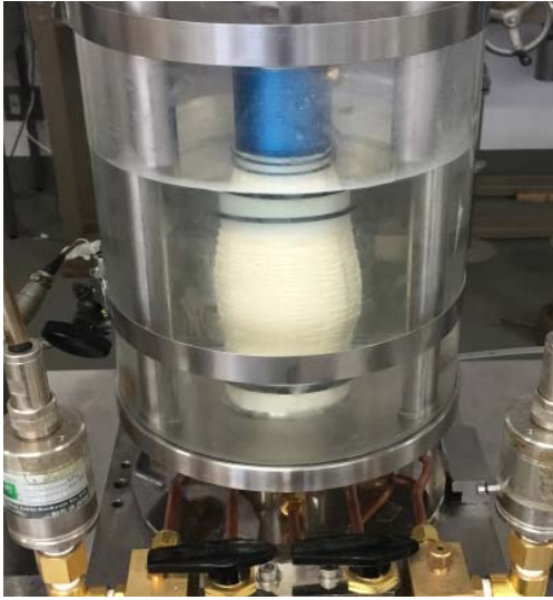
(a) 圧縮中の供試体の様子
