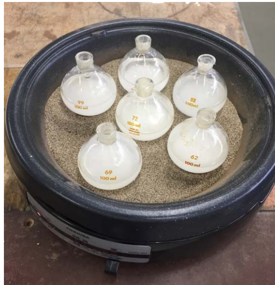
写真 2-2 試験状況（土粒子の密度試験）
