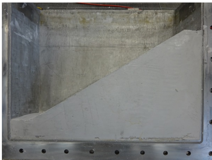
写真 3-21 型枠設置方式の斜面模型地盤作製完了
