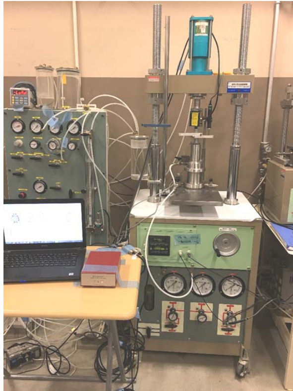
写真 2-8 定ひずみ速度圧密試験装置
