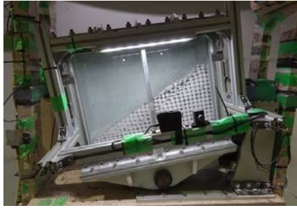
写真-1 土槽の傾斜による静的震度の作用状況
