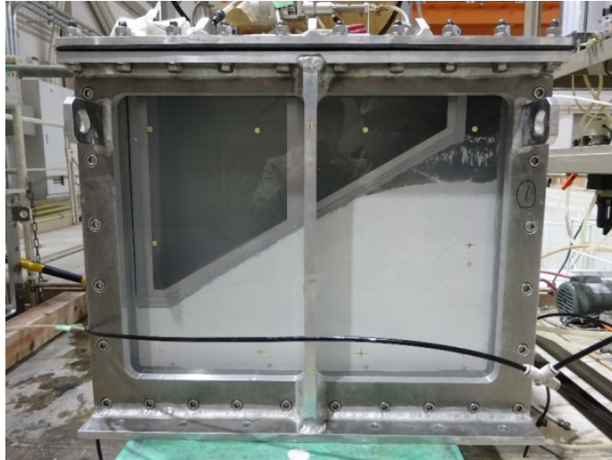
写真 3-17 浸透圧密状況（土槽側面）
