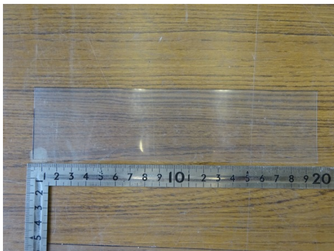
写真 3-22 クラックを保持するためのビニールフィルム
