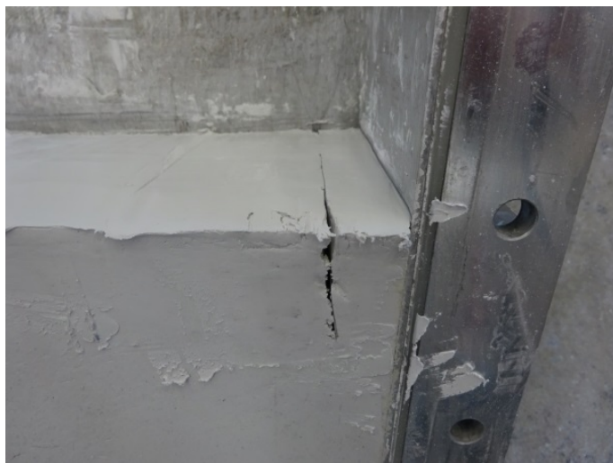
写真 3-27 クラック作製完了
