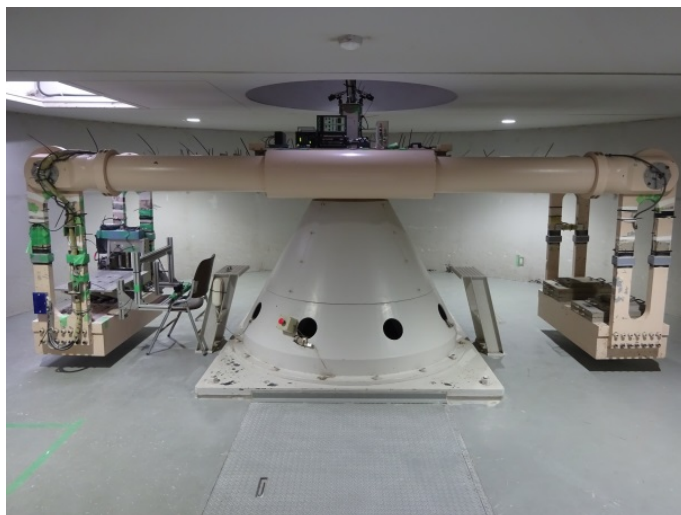
写真 4-1 遠心模型実験装置
