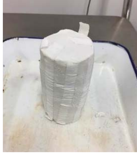
(b) 圧縮後の供試体の様子
