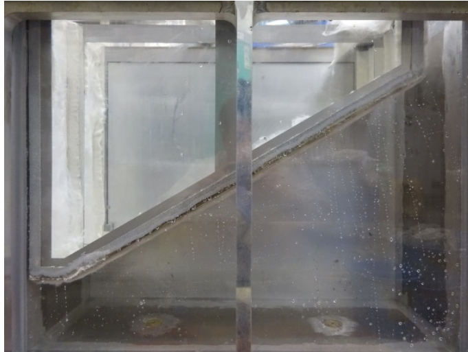
写真 3-14 型枠の設置（土槽側面から見た状況）
