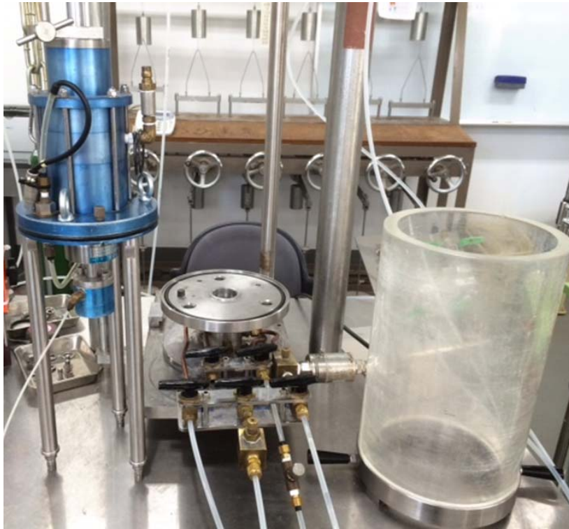
写真 2-5 三軸圧縮試験機（分解時）
