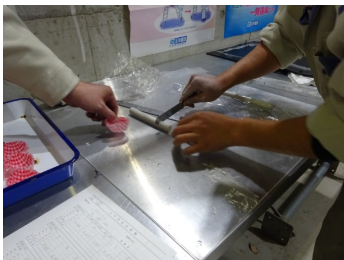
写真 3-9 含水比測定状況
