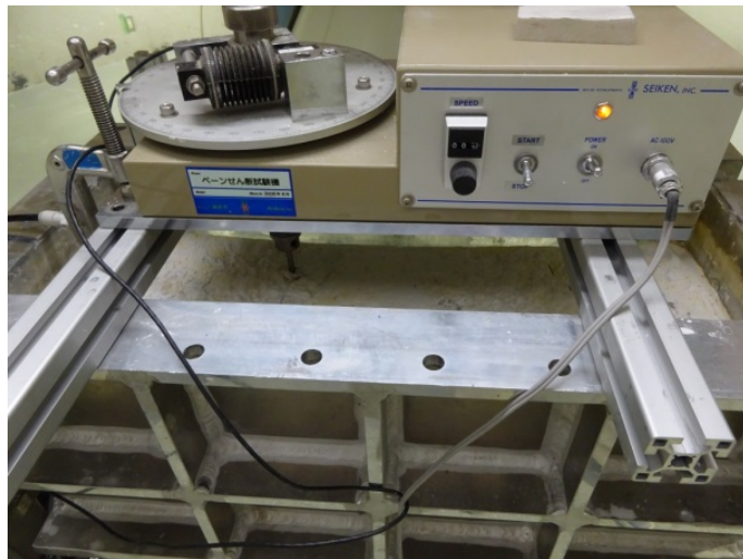
写真 3-29 ベーンせん断強度試験
