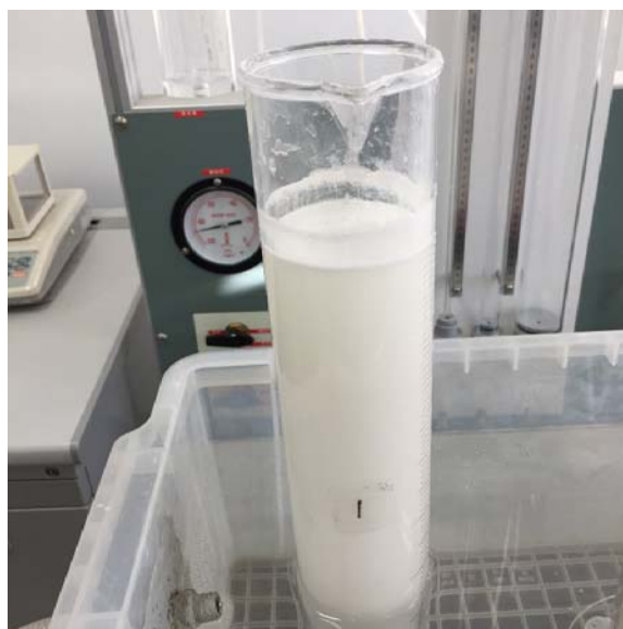
写真 2-3 試験状況（粒度試験（沈降分析））
