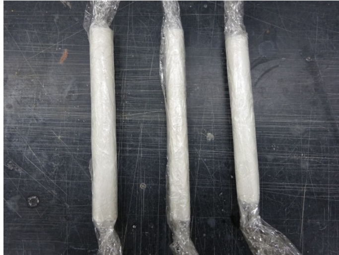
写真 3-30 凍らせたサンプリング試料
