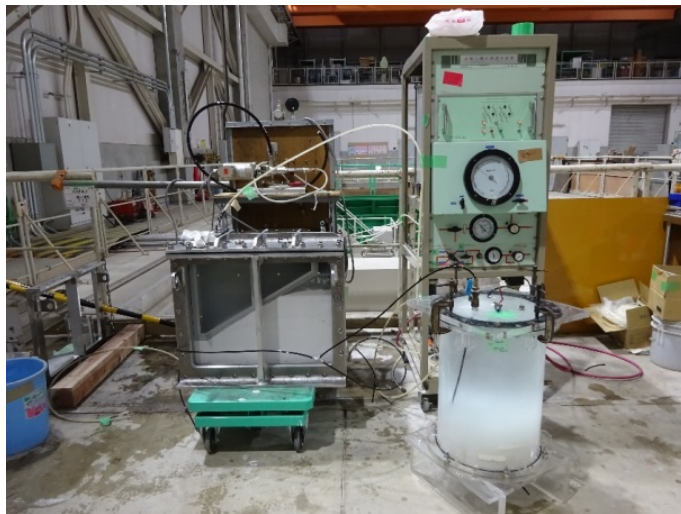
写真 3-16 浸透圧密状況（全景）
