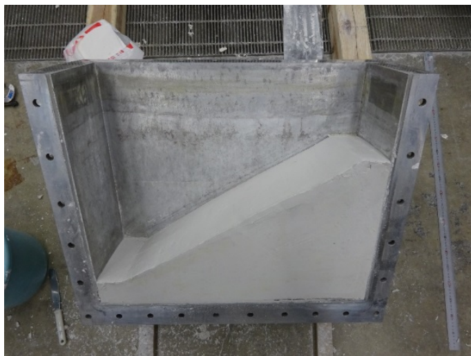
写真 3-12 水平切出し方式の斜面模型地盤作製完了
