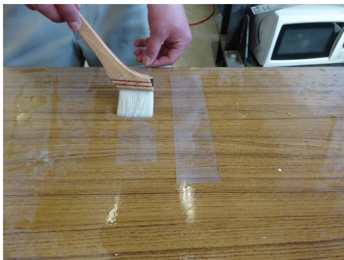
写真 3-23 ビニールフィルムへのグリス塗布状況
