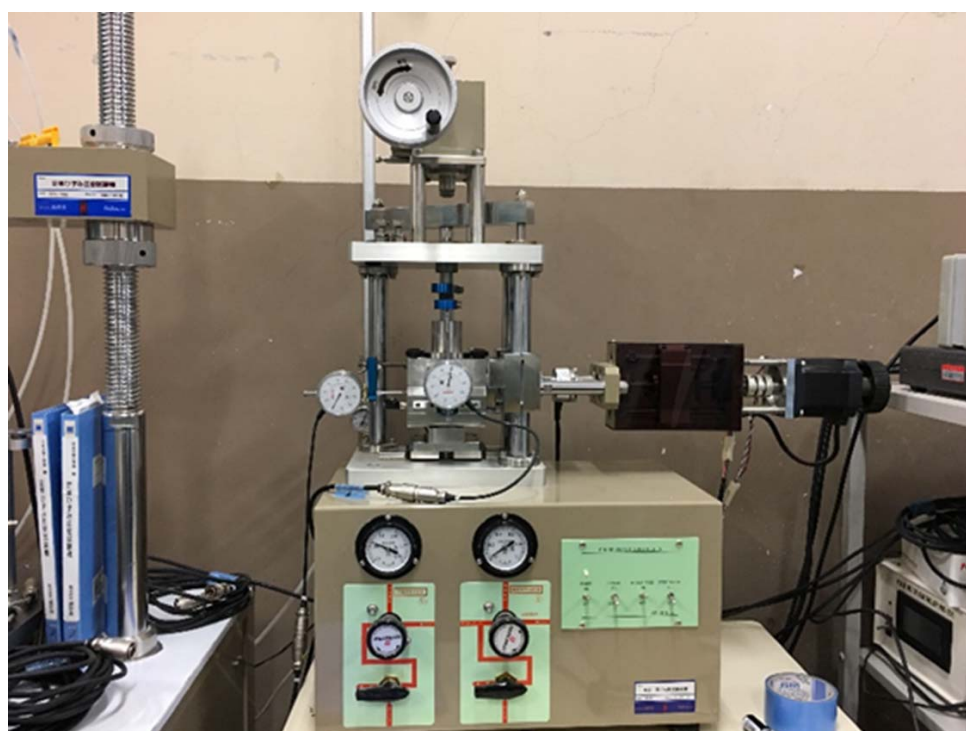
写真 2-7 一面せん断試験装置
