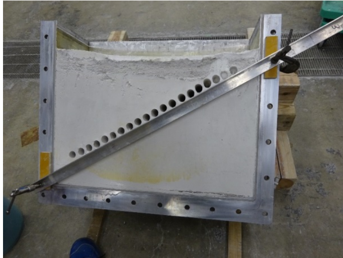
写真 3-10 地盤切り出し状況
