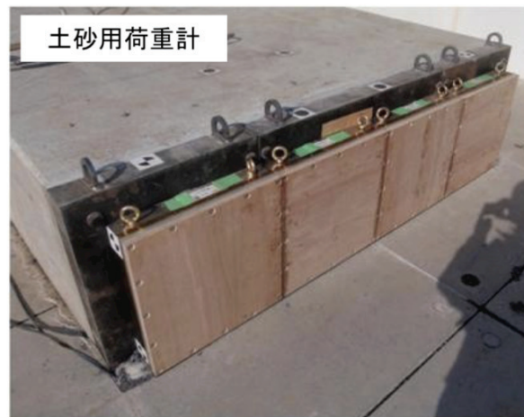
写真3.3.1.1-5 反力壁と荷重計
