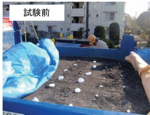
写真 3.3.1.1-6 土砂挙動の計測に用いた標点用に白色小石
