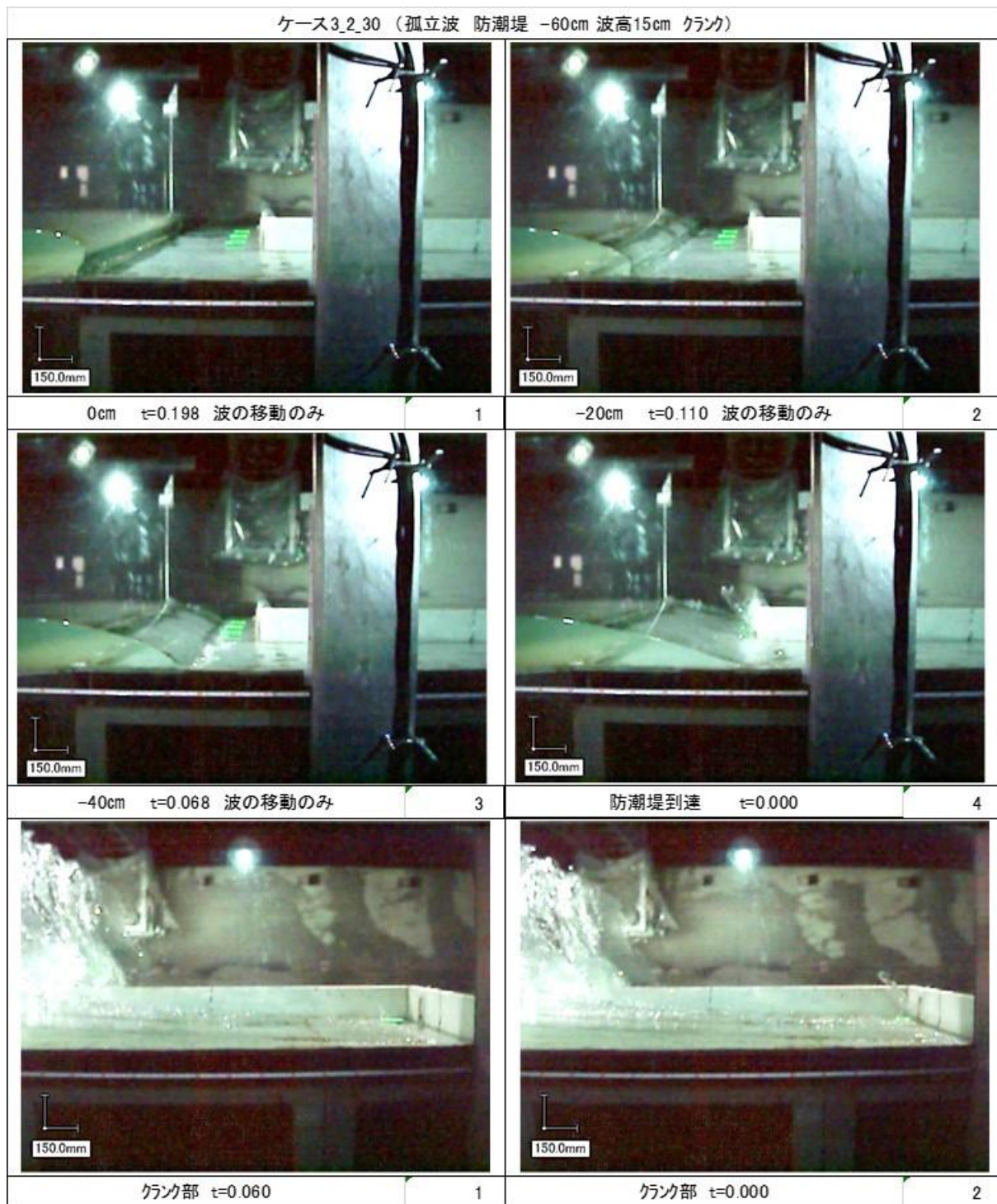
写真 4-3-5 漂流物衝突試験流況 (孤立波, 防潮堤-60cm, クランクあり, 流木)
