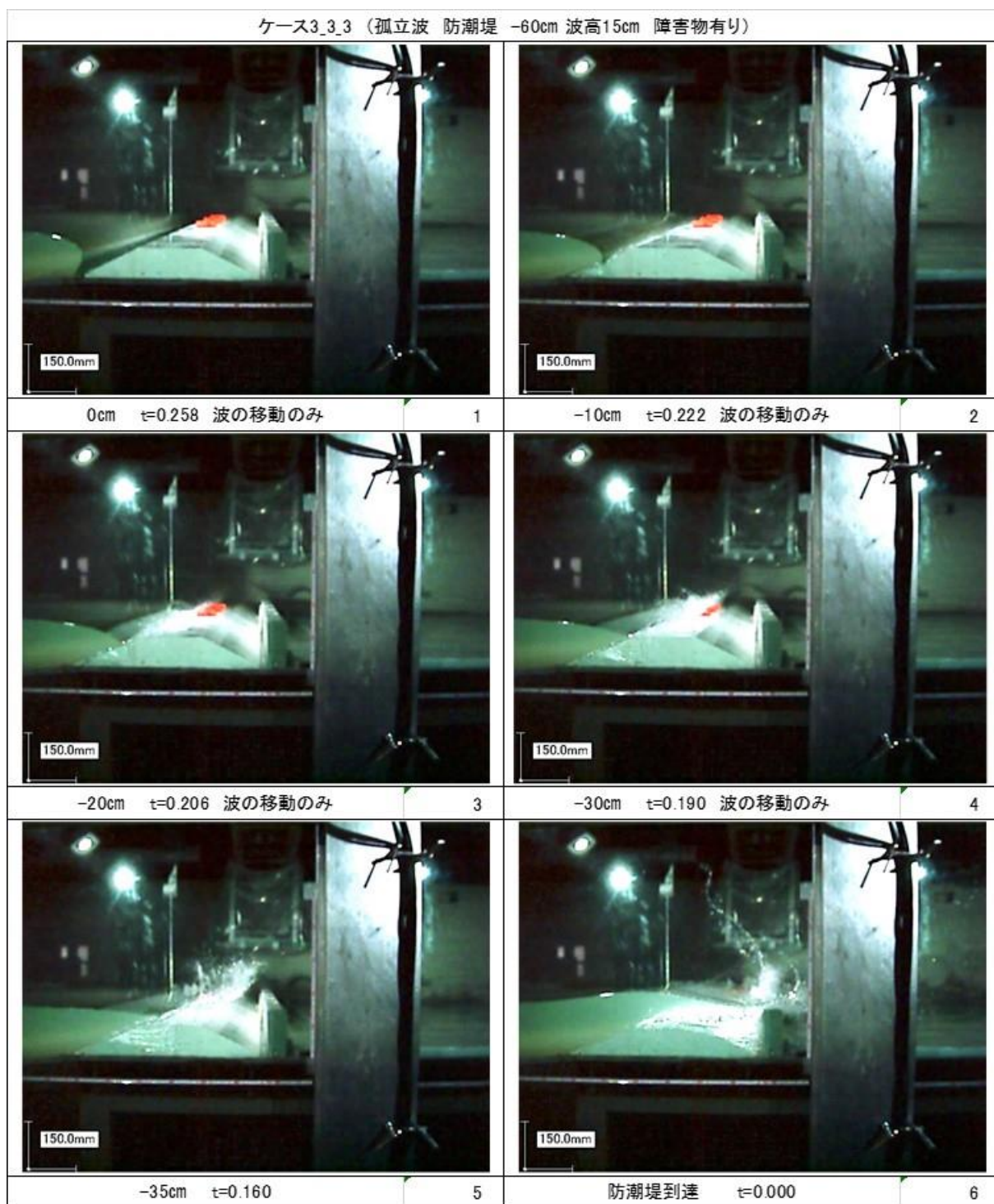
写真 4-3-10 漂流物衝突試験流況（孤立波，防潮堤-60cm，小型船舶，障害物あり）
