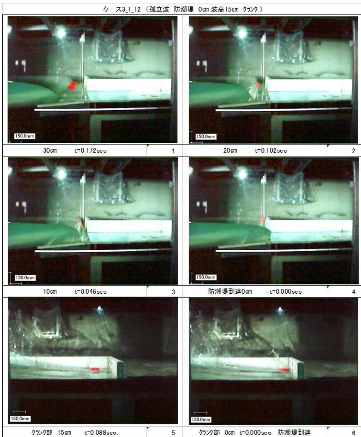
写真 4-3-2 漂流物衝突試験流況 (孤立波, 防潮堤 0cm, クランクあり, 小型船舶)
