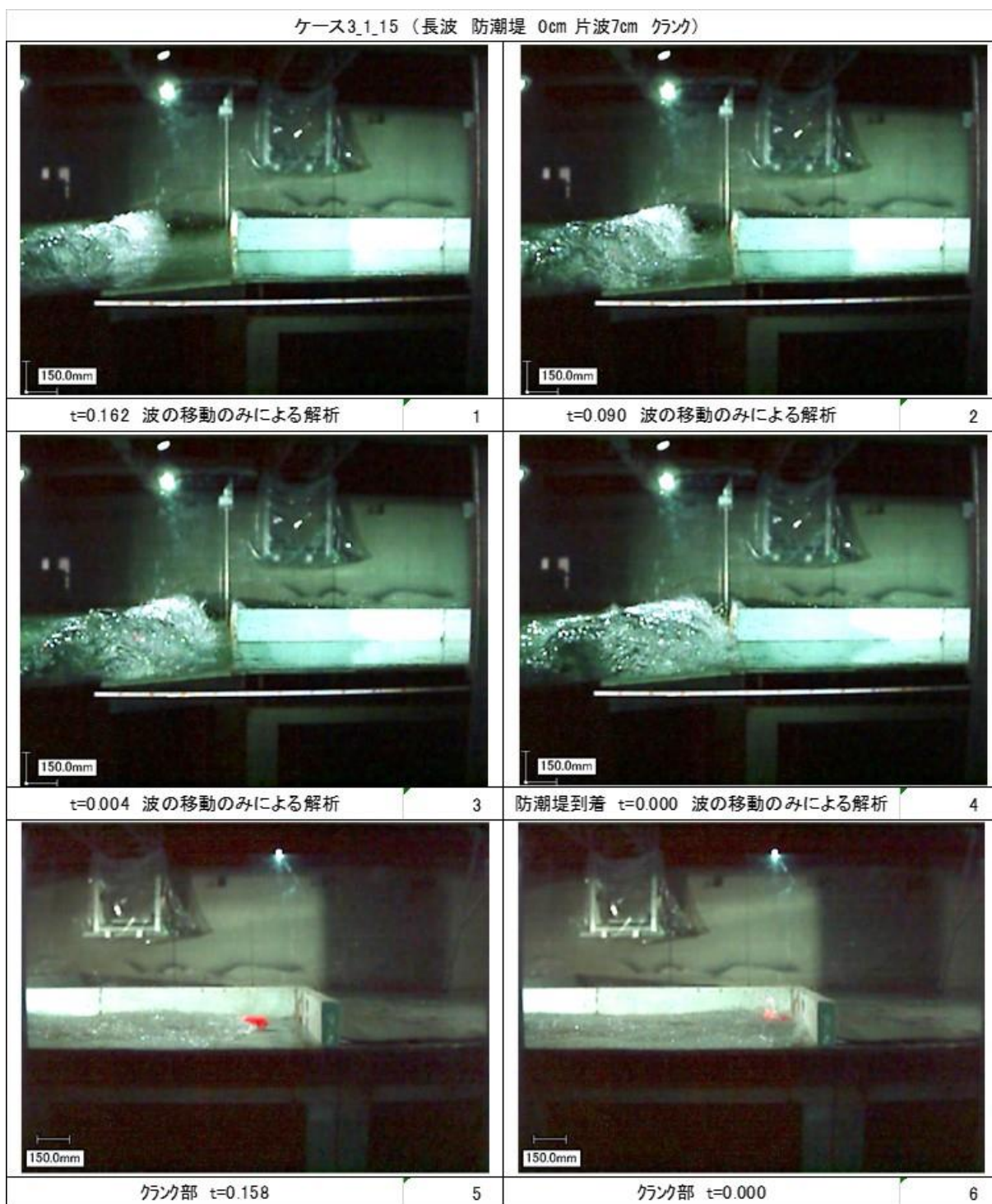
写真 4-3-6 漂流物衝突試験流況 (長波, 防潮堤 0cm, クランクあり, 小型船舶)
