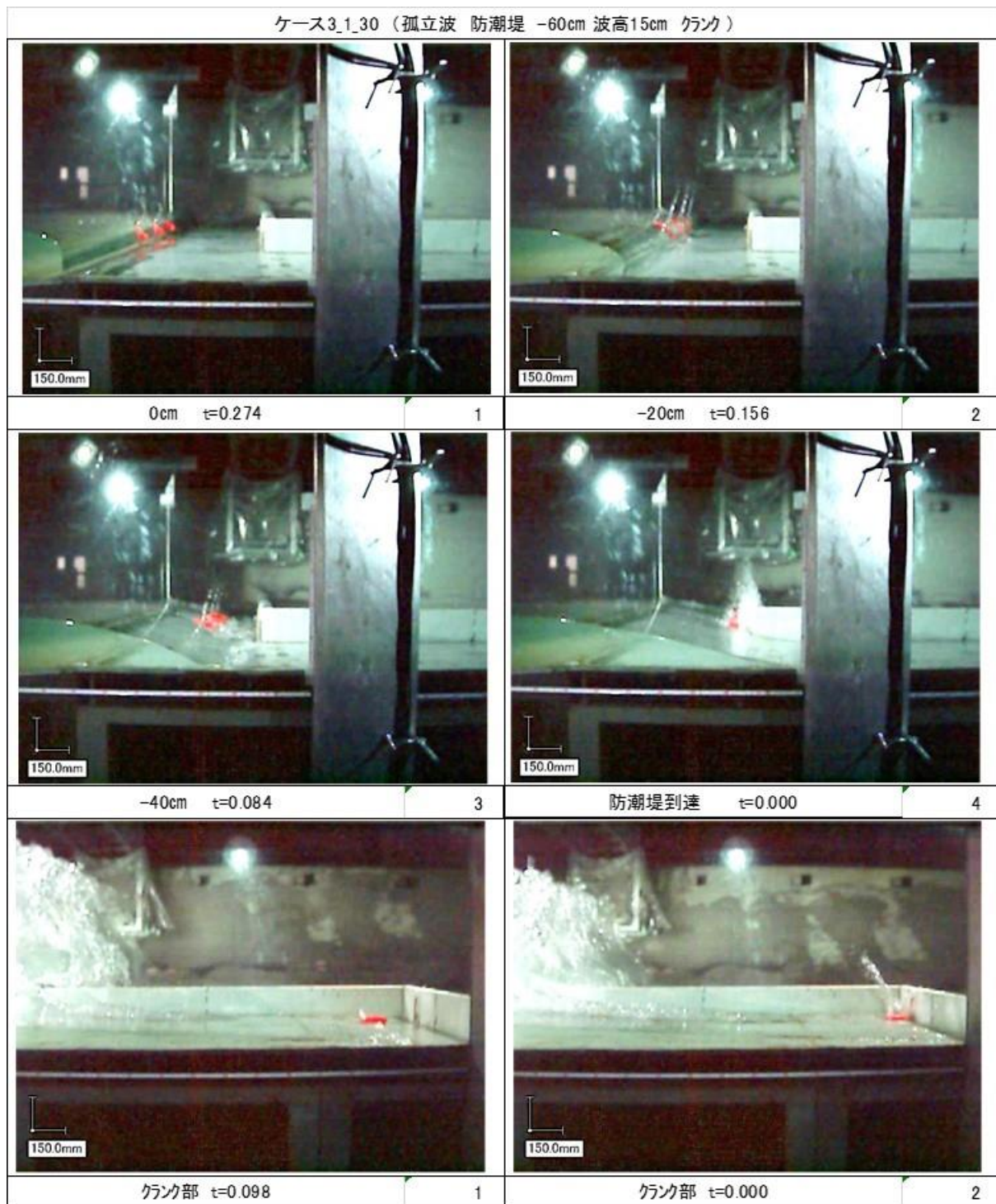
写真 4-3-3 漂流物衝突試験流況（孤立波，防潮堤-60cm，クランクあり，小型船舶）
