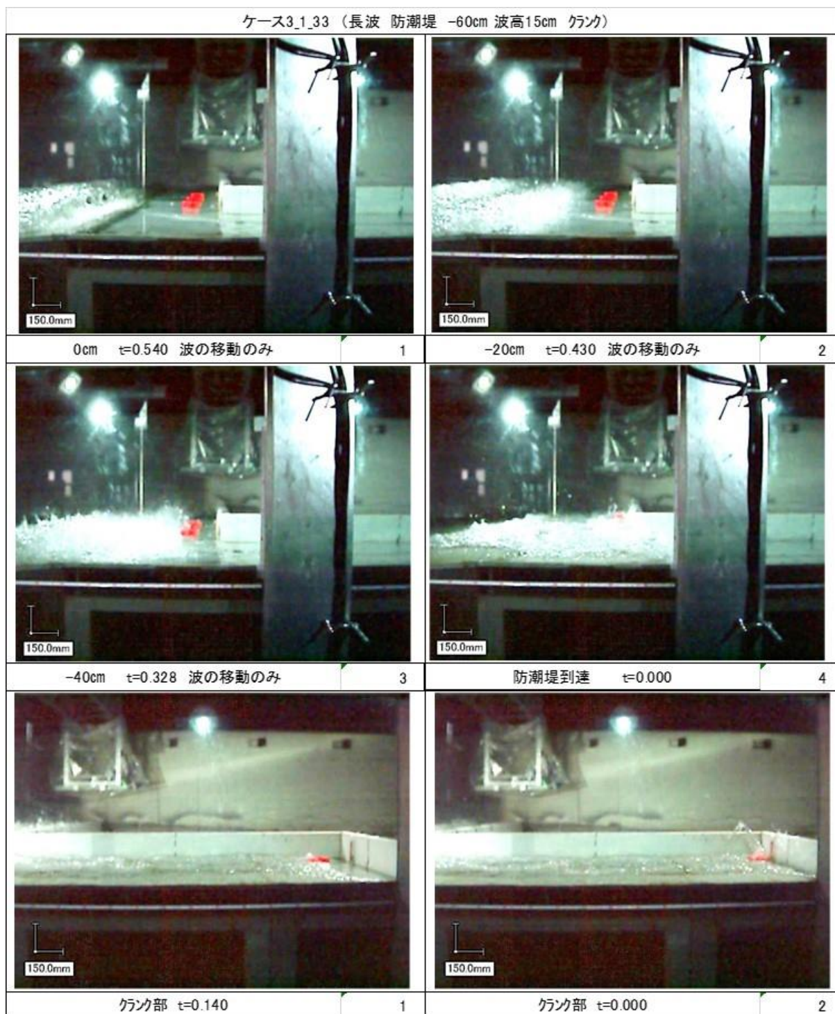
写真 4-3-7 漂流物衝突試験流況 (長波, 防潮堤-60cm, クランクあり, 小型船舶)
