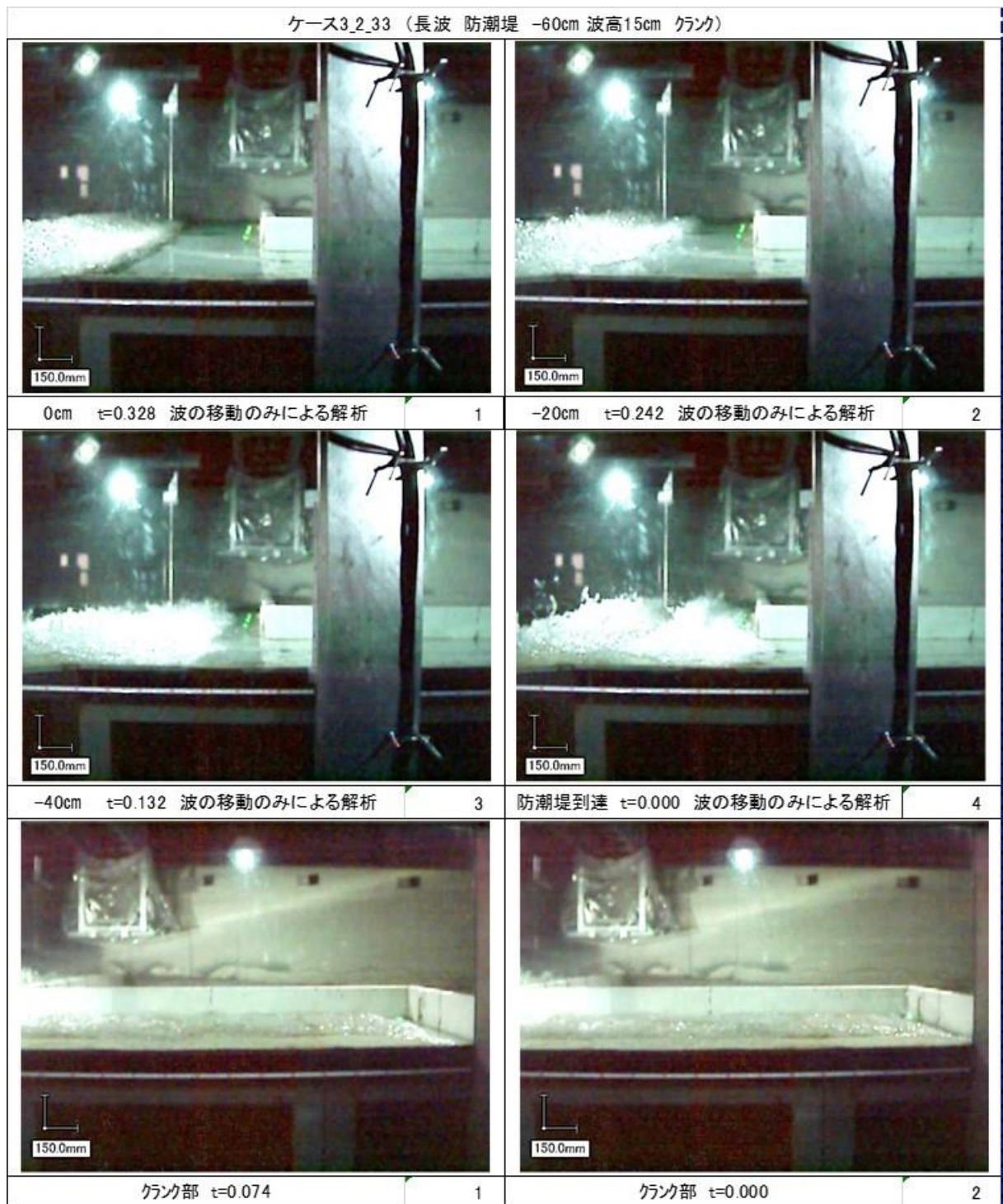
写真 4-3-9 漂流物衝突試験流況 (長波, 防潮堤-60cm, クランクあり, 流木)
