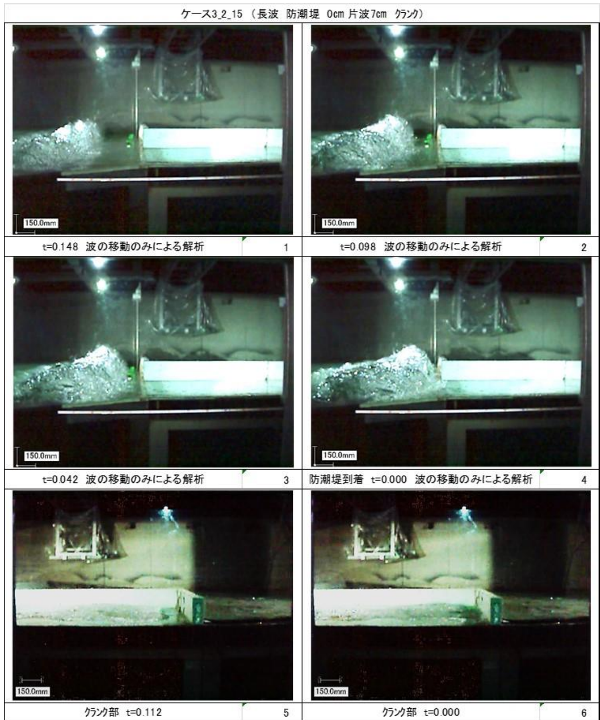
写真 4-3-8 漂流物衝突試験流況 (長波, 防潮堤 0cm, クランクあり, 流木)
