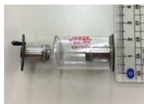
電極が分離したスパークギャップ
