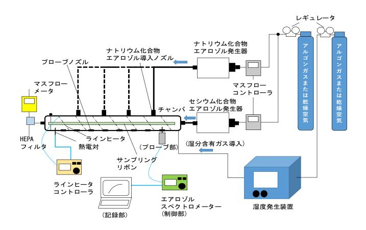
図1 エアロゾル挙動試験装置の概要
