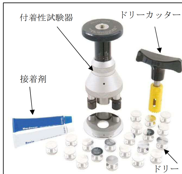
図 プルオフ法の試験機材（例）
