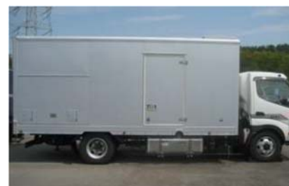
可搬型代替交流電源設備
