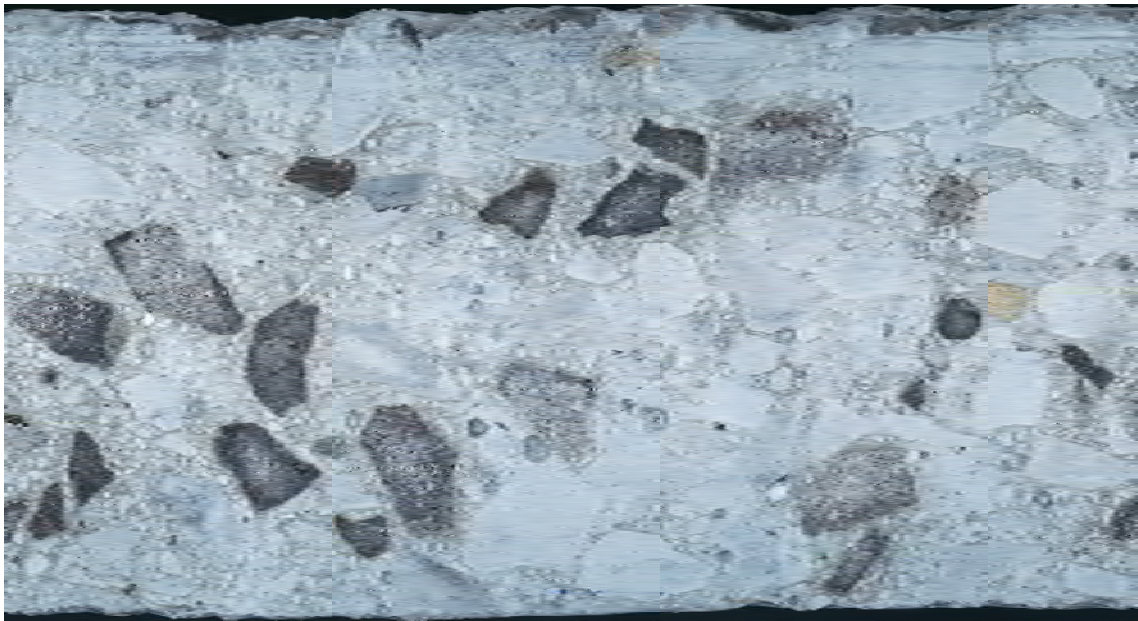
付図 1.5 コンクリートコア展開写真 (F55601、可視光源、75mm×141mm)
