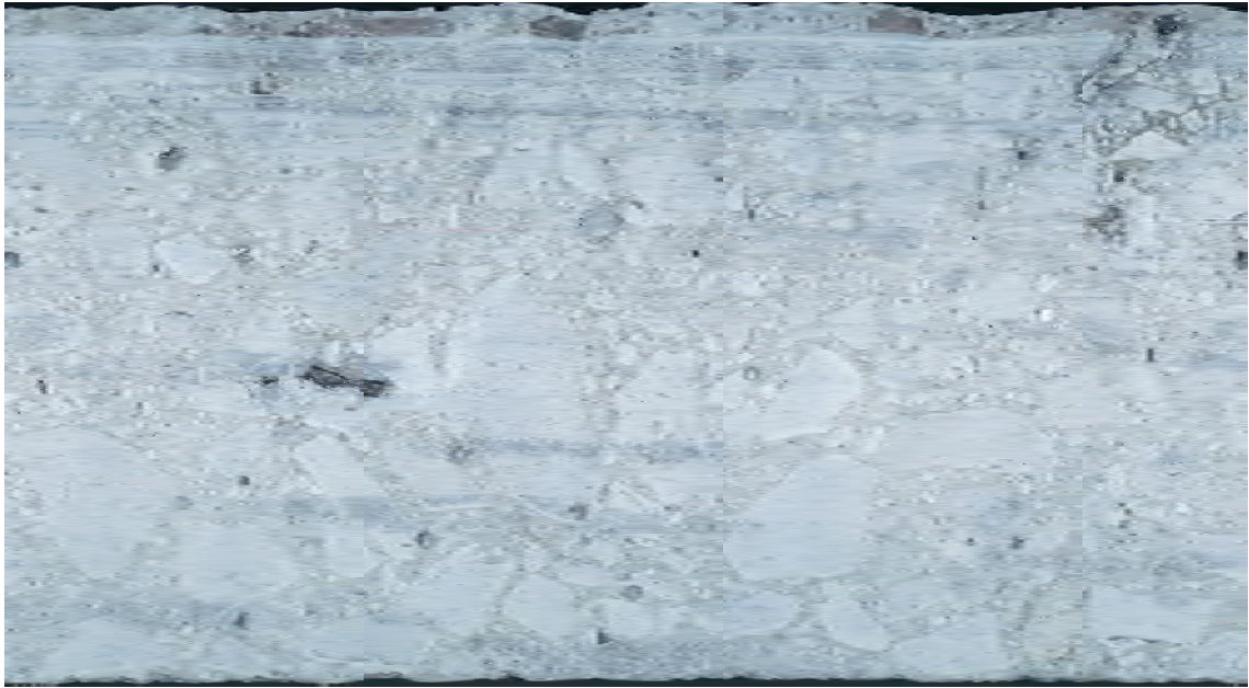
付図 1.9 コンクリートコア展開写真 (I055601、可視光源、75mm×141mm)
