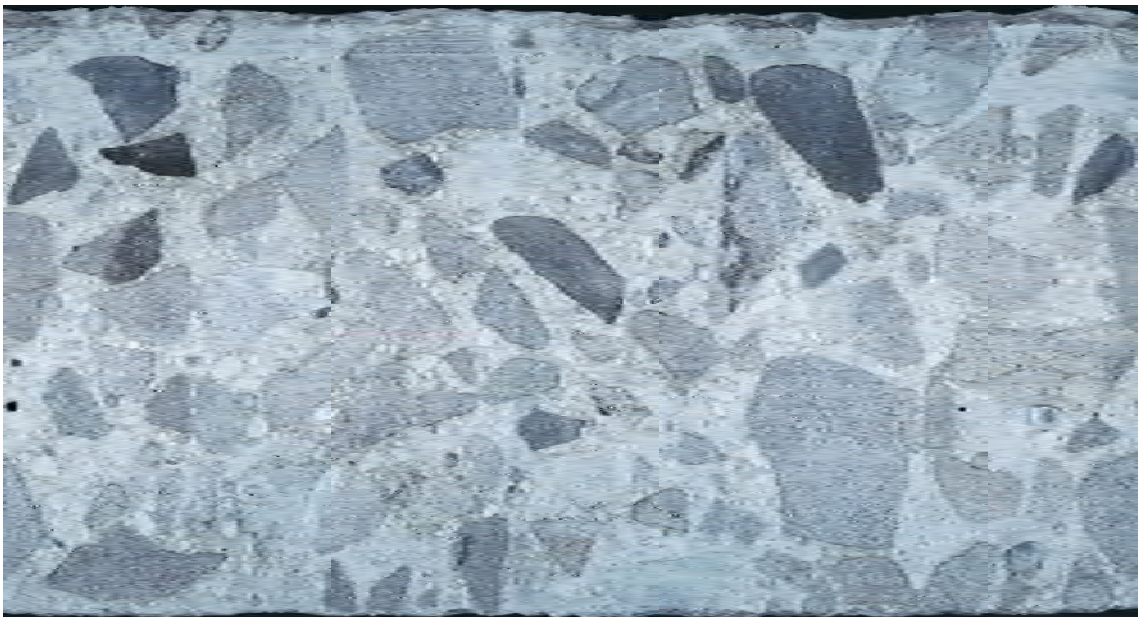
付図 1.7 コンクリートコア展開写真 (WI425381、可視光源、75mm×141mm)
