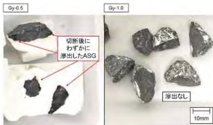
図 3.15 石膏ペースト中の骨材 T0 断面
