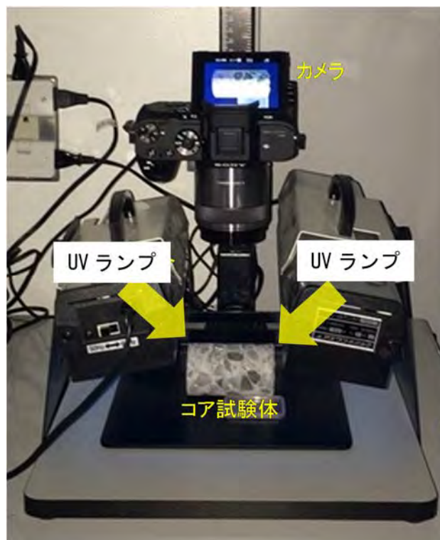
図 4.11 コンクリートコア外観観察マクロ写真撮影状況（蛍光法）
