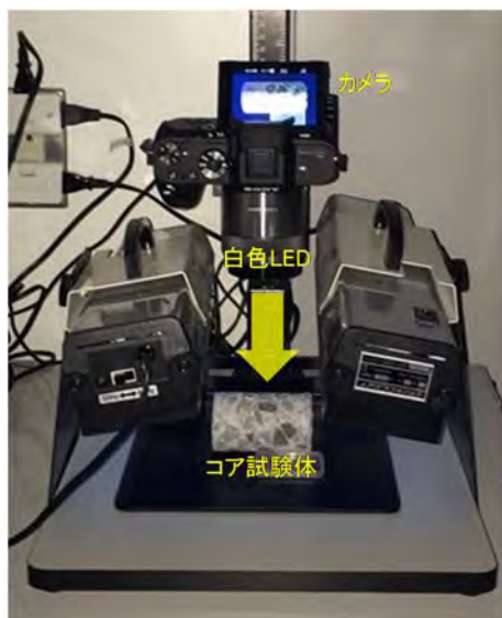
図 4.8 コンクリートコア外観観察マクロ写真撮影状況（可視光源）
