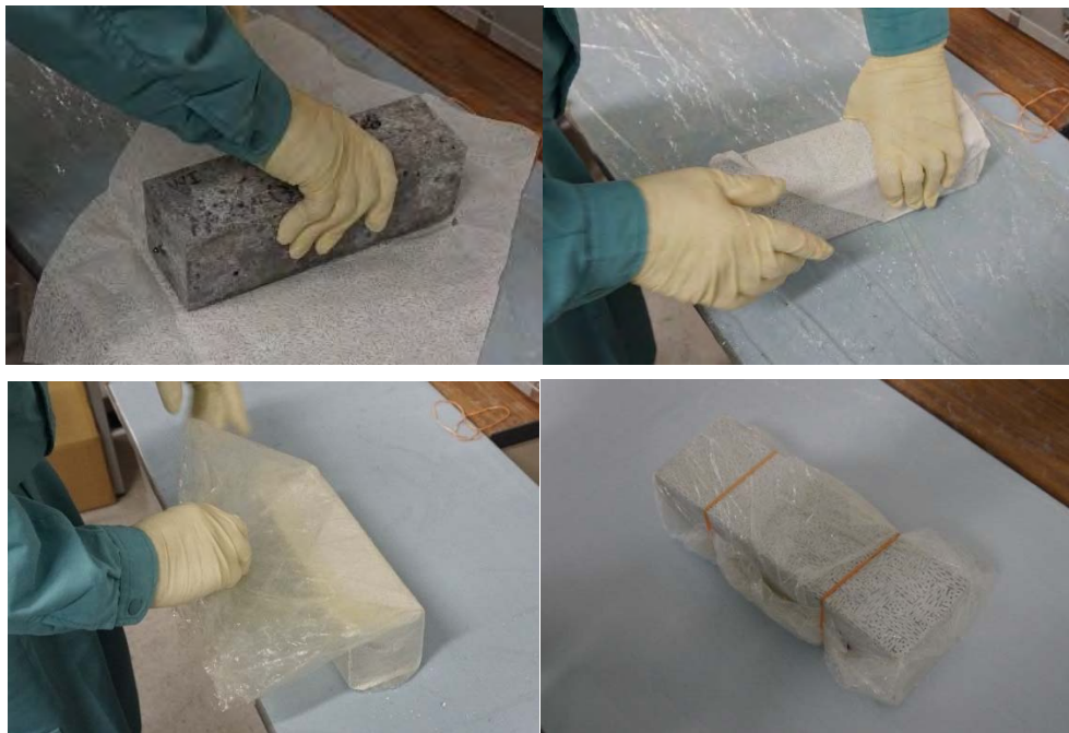
図 4.6 促進養生前に不織布（AW）を施した試験体
