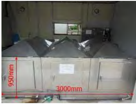
(a) 養生槽外観
