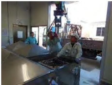
(c) 養生槽への収納状況
