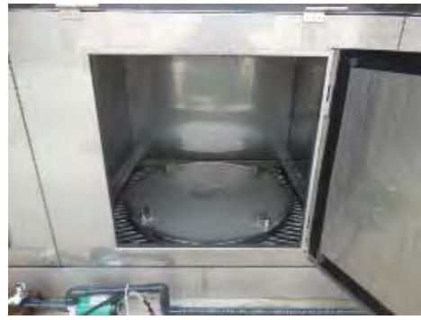
(b) 内部(下部に温水を循環させ、槽内温度を制御)
