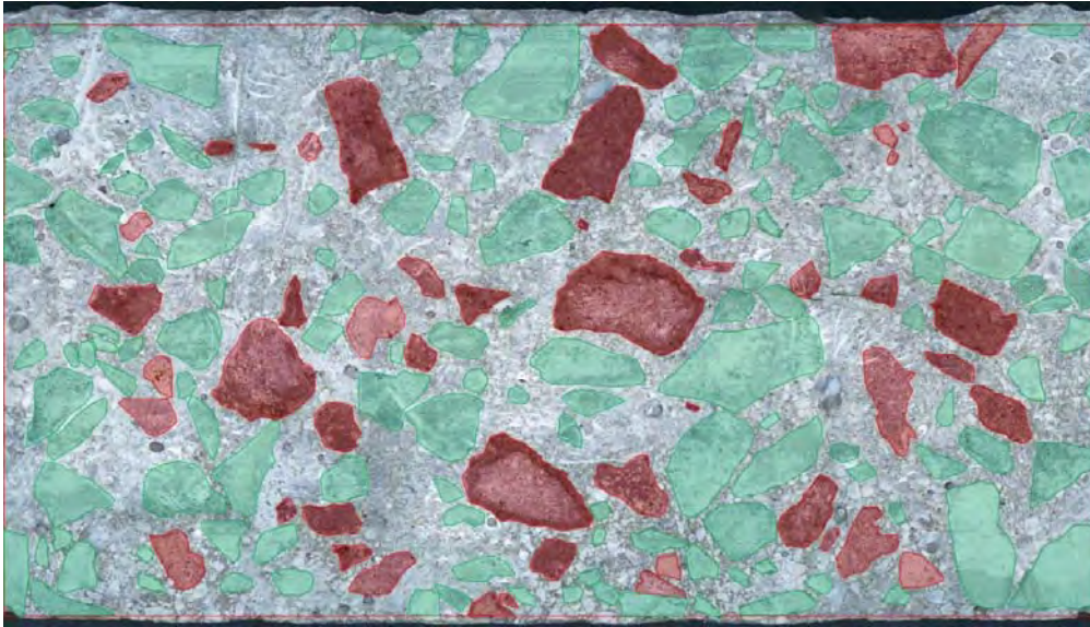
図 4.13 粗骨材 T0 の岩種構成定量例 (55381、75mm×141mm)
