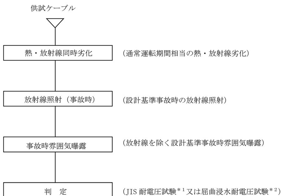
図 1.2 同軸ケーブルの ACA ガイドに基づく試験手順
