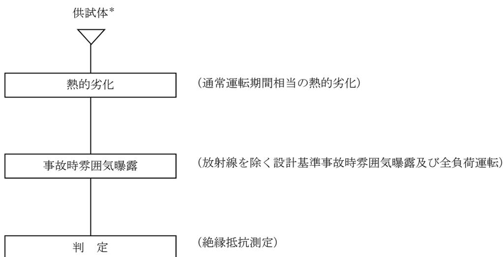
\*：供試体は、東海第二で使用している「高圧炉心スプレイ系ポンプモータ」、**「低圧炉心スプレイ系ポンプモータ」**、「残留熱除去系ポンプモータ」と同等の高圧モータ
