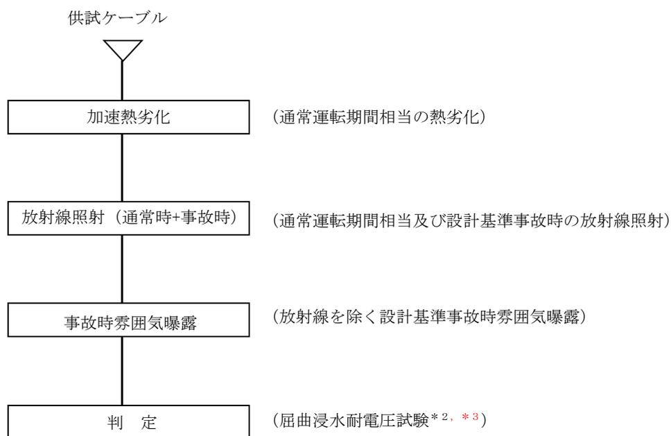
図 1.1 同軸ケーブルの長期健全性試験手順（電気学会推奨案）
