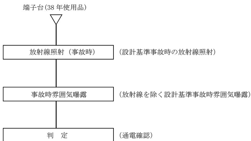
図 1.1 端子台接続（原子炉格納容器内）の長期健全性試験手順
