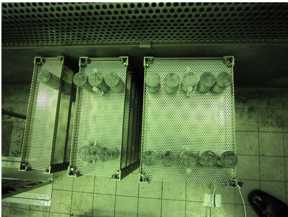
(a)線量計配置状況 (1)
