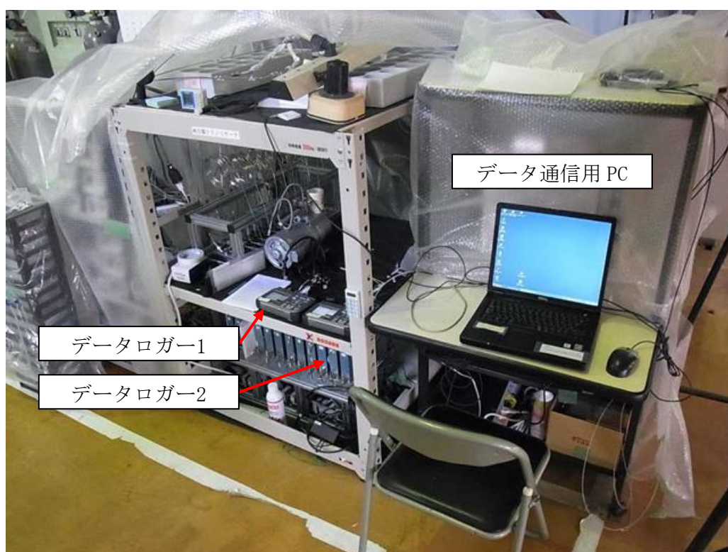
図 3. 67 照射室外計測システム外観
