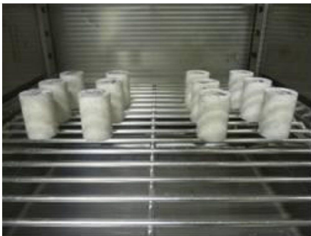
図 3.25 試験体設置状況（照射試験 4 列目模擬）
