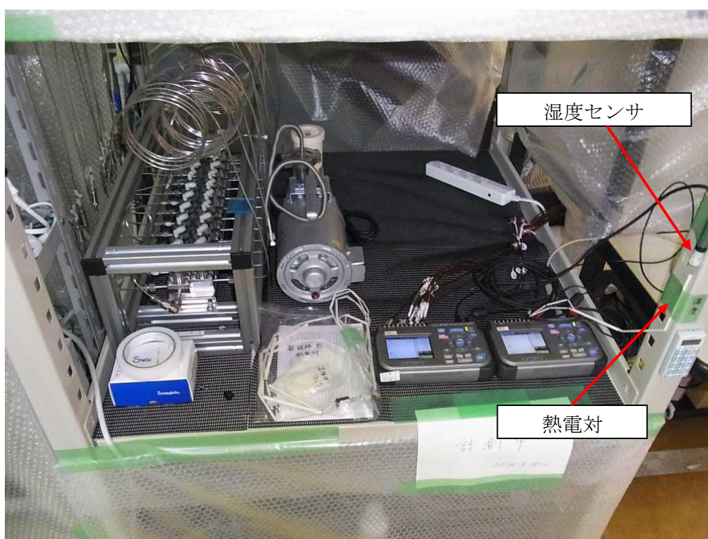
図 3.69 照射室外湿度センサおよび熱電対設置箇所
