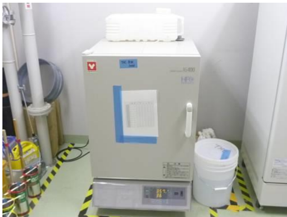
図 3.22 恒温恒湿槽：IG400（照射試験 1列目模擬）
