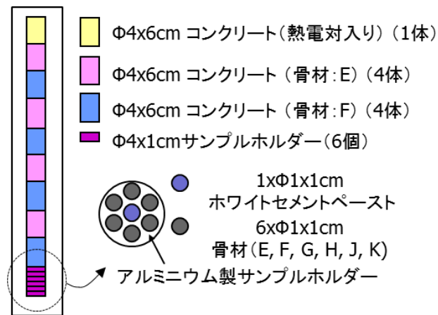
図 2.4 物理特性試験キャプセル内部の試験体の設置状況
