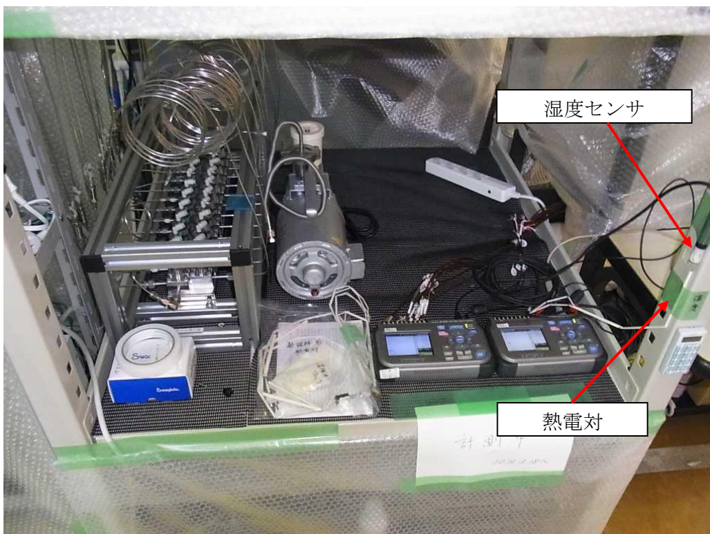
図 3.10 照射室外湿度センサーおよび熱電対設置箇所
