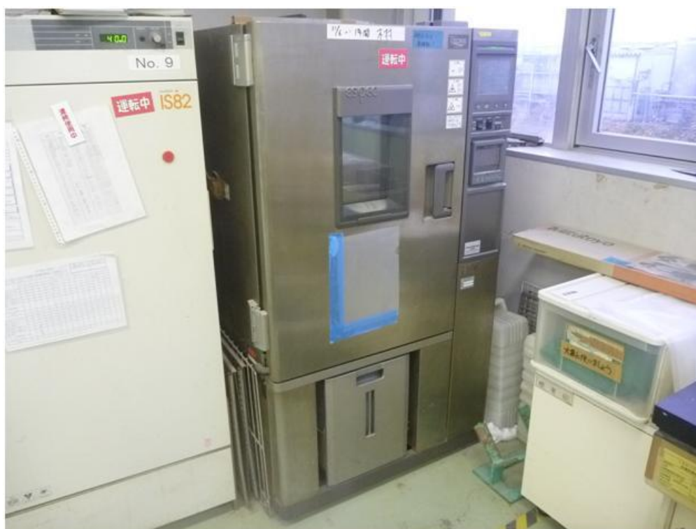
図 3.24 恒温恒湿槽：PR-2K（照射試験 4 列目模擬）
